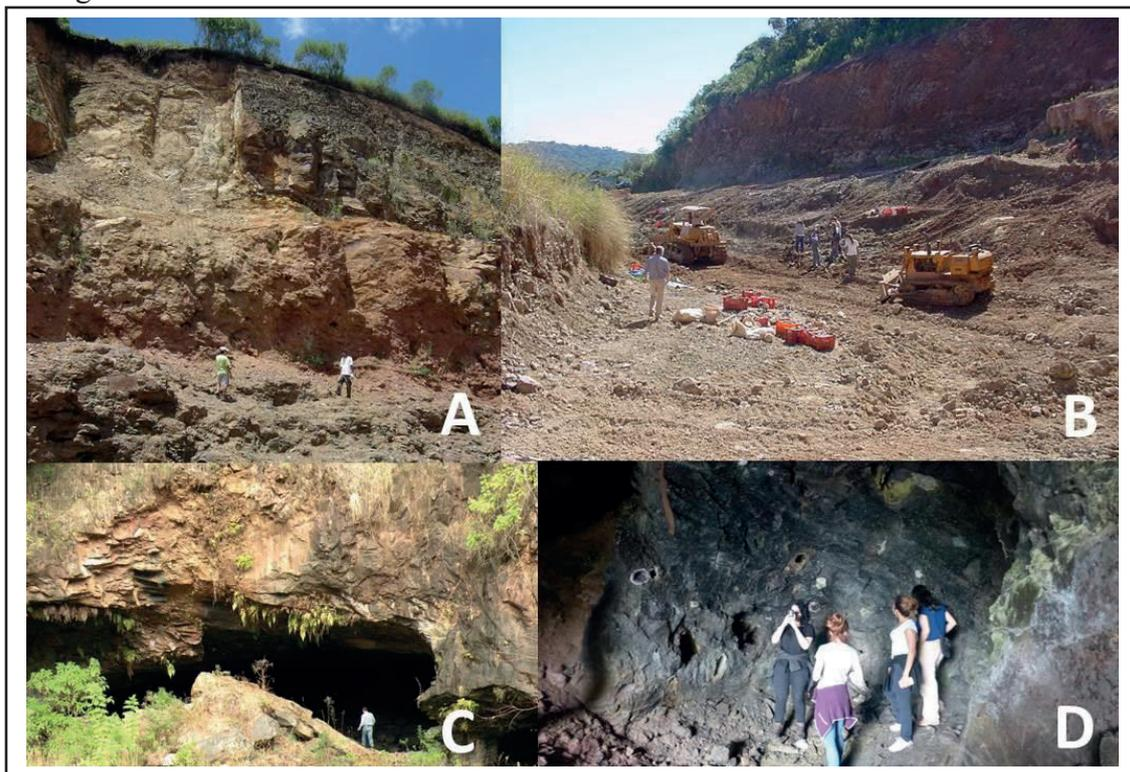
**Figura 1** – Frentes de lavra nos garimpos estudados. A – Talude de lavra em Galópolis (CX2), com altura aproximada de 30 metros, em rocha alterada, mas ainda consistente. B – Garimpo desenvolvido em regolitos, em Santa Lúcia do Piaí (CX1); C e D – Cavas subterrâneas, abertas em vitrófiros do tipo *pichstone* (NB).
