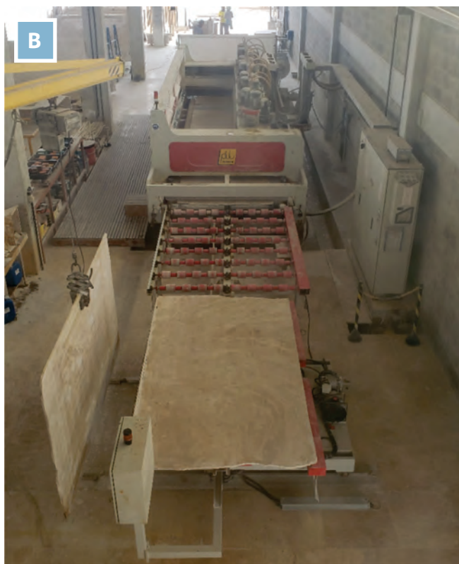
Figura 5.5 – Politriz automática utilizada no polimento do mármore Bege Bahia, Ourolândia (BA). A) Aspecto geral da politriz automática. B) Detalhe da chapa Bege Bahia na politriz.
