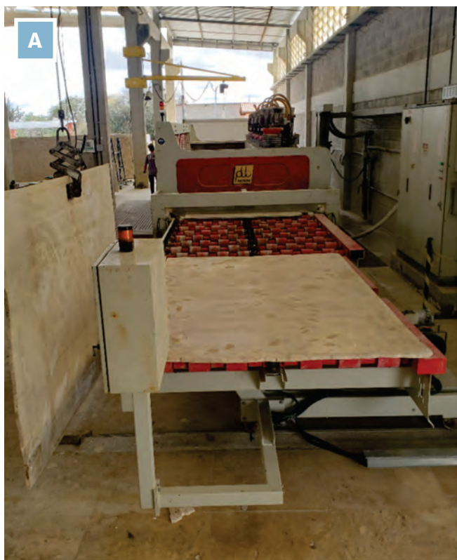
Figura 5.5 – Politriz automática utilizada no polimento do mármore Bege Bahia, Ourolândia (BA). A) Aspecto geral da politriz automática. B) Detalhe da chapa Bege Bahia na politriz.
