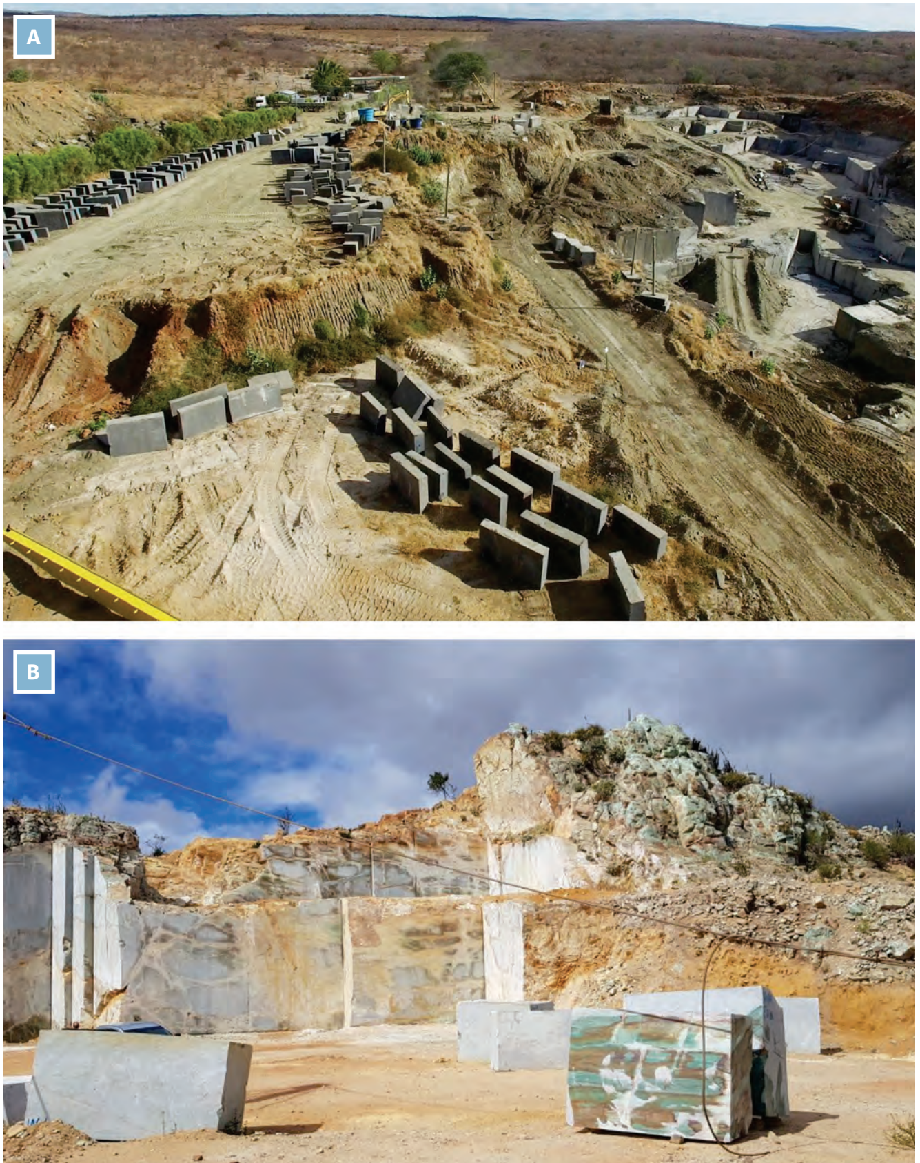
Figura 5.3 – A) Extração de granito preto em duas bancadas (lado direito da foto), Guajeru (BA). B) Frente de lavra de quartzo com evidência do uso de fio diamantado, Jaguarari (BA).
