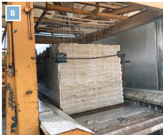
Figura 5.4 – A) Tear diamantado cortando bloco de rocha ornamental, tipo Bege Bahia, Ourolândia (BA). B) Detalhe do corte do bloco.
