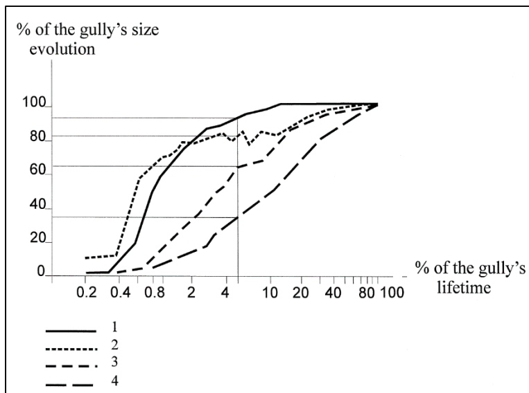
Figura 3.7- Evolução da morfologia de uma voçoroca durante seu tempo de vida (Sidorchuk 1999). 1 – comprimento; 2 – profundidade; 3 – área; 4 – volume.
