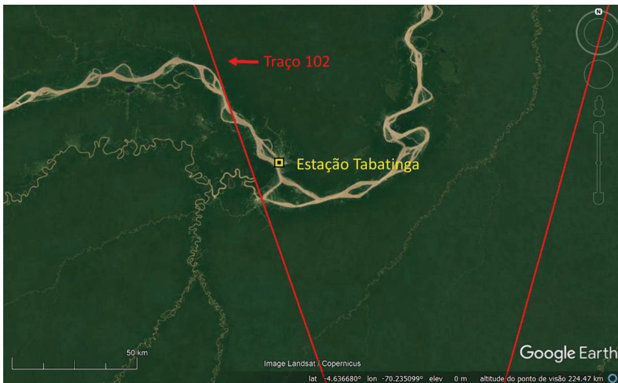
Figura 19. Estação linimétrica de Tabatinga (10100000), identificada pelo marcador amarelo, traço #102, do satélite Jason 2, em linha vermelha. Mosaico de imagens do *Google Earth* em segundo plano.
