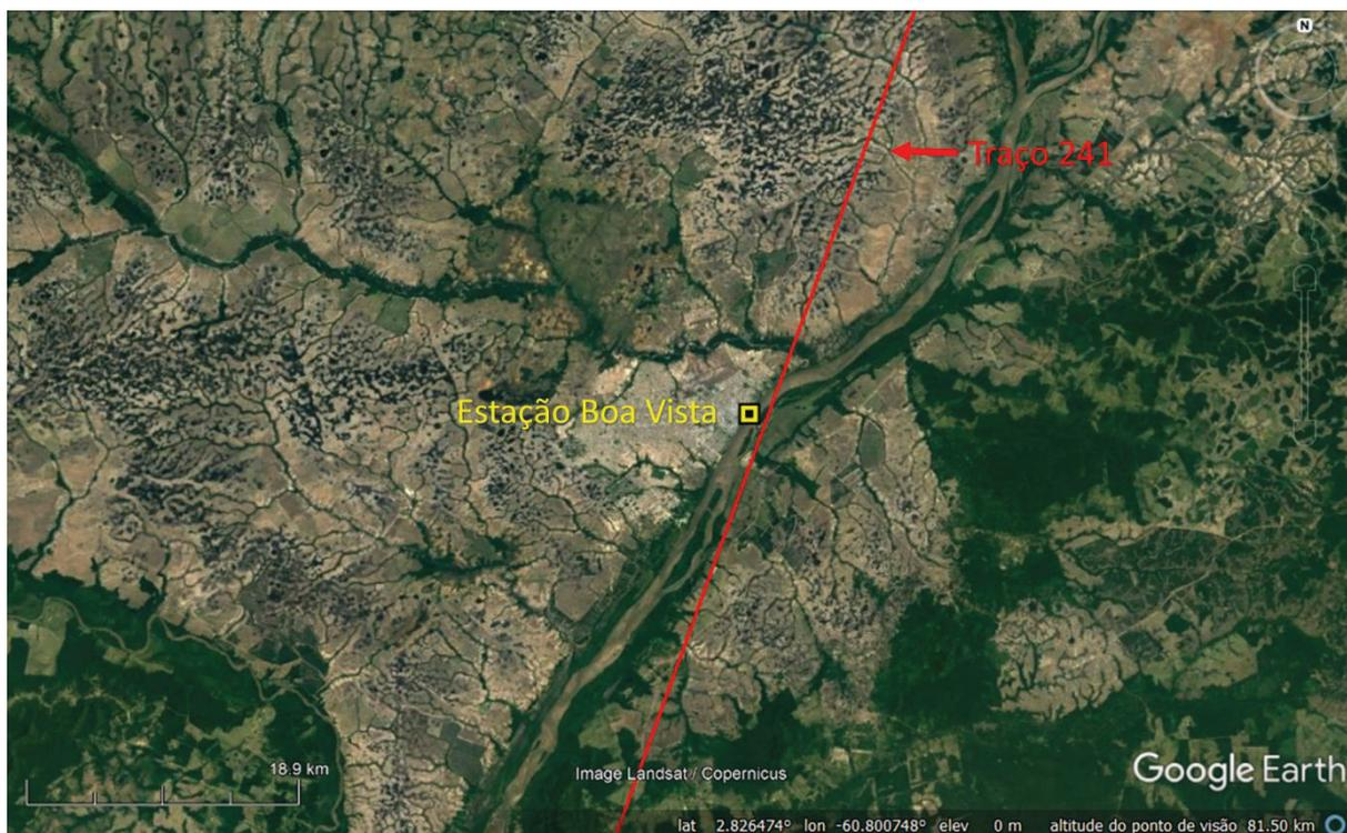
Figura 15. Estação linimétrica de Boa Vista, identificada pelo marcador amarelo, traço #241, do satélite Jason 2, em linha vermelha. Mosaico de imagens do *Google Earth* em segundo plano.
