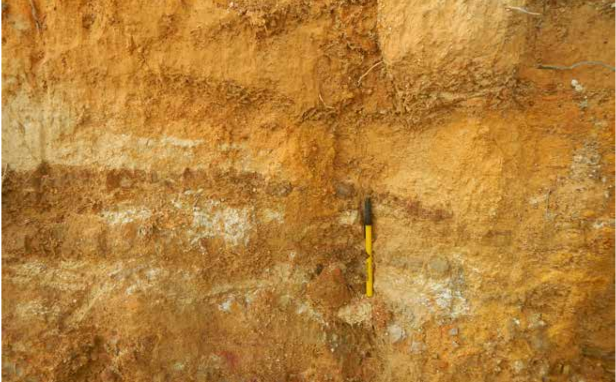
Figura 4.20. Presença de óxidos de ferro no manto de alteração de rocha gnáissica em corte de estrada na Serra da Dona Francisca (latitude 26° 12' 47,5" S; longitude 49° 03' 07" O).
