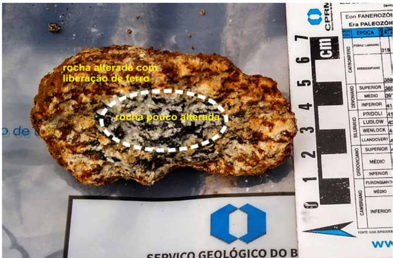
Figura 4.19. Auréola de alteração em gnaiss granulítico liberando o óxido de ferro de minerais máficos (amostra coletada na localidade Rio Bonito (latitude 26° 08' 52" S; longitude 48° 54' 53,6" O).
