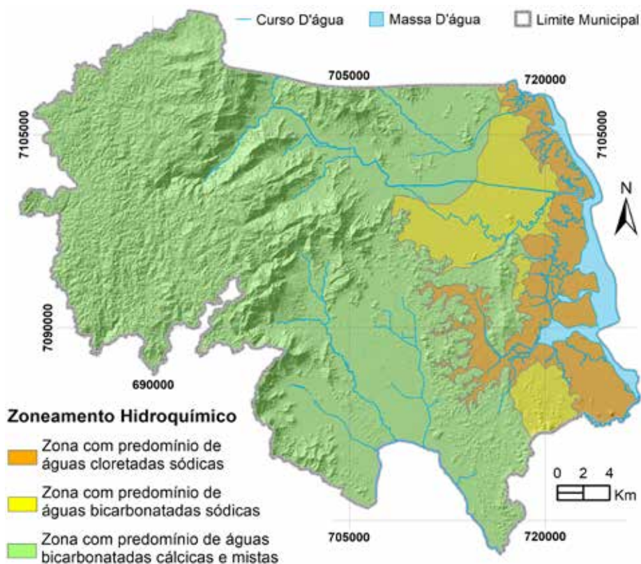
Figura 4.47. Zoneamento hidroquímico das águas subterrâneas em Joinville.
