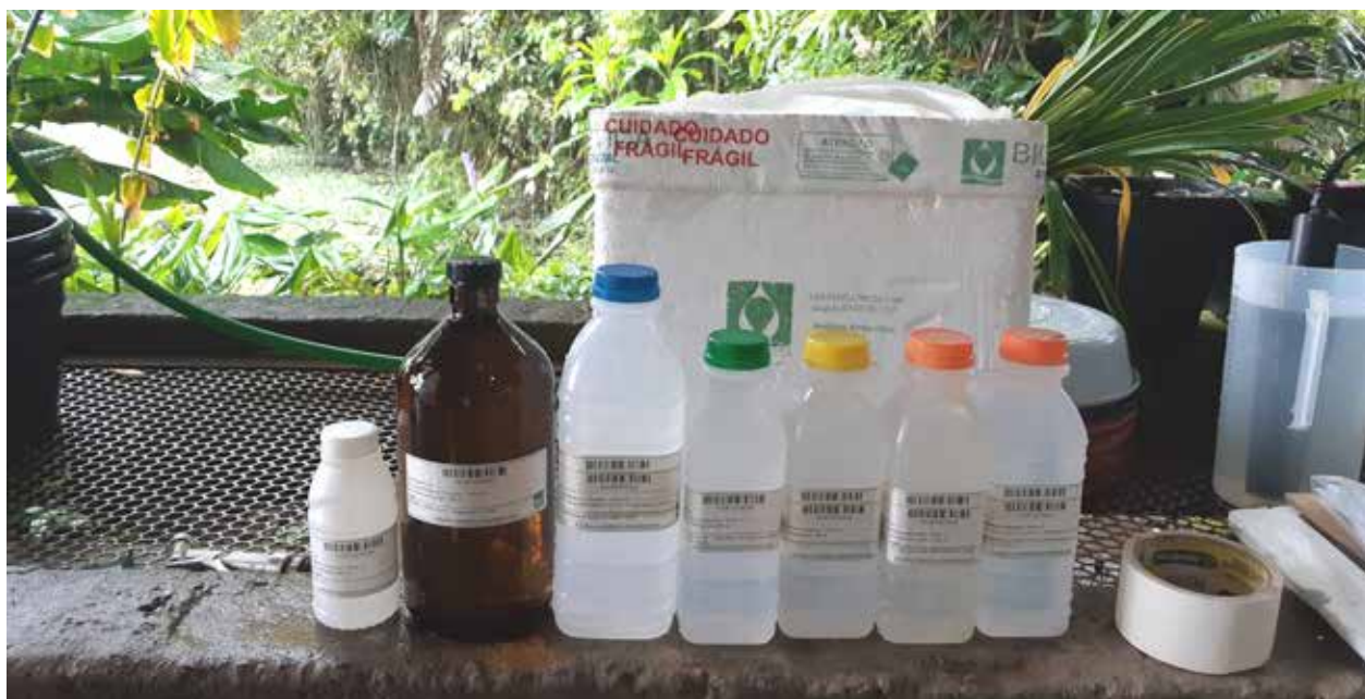
Figura 3.4. Acondicionamento das amostras em caixas de isopor contendo bolsas de gelo gel, para preservação das amostras durante o envio ao laboratório analítico.
