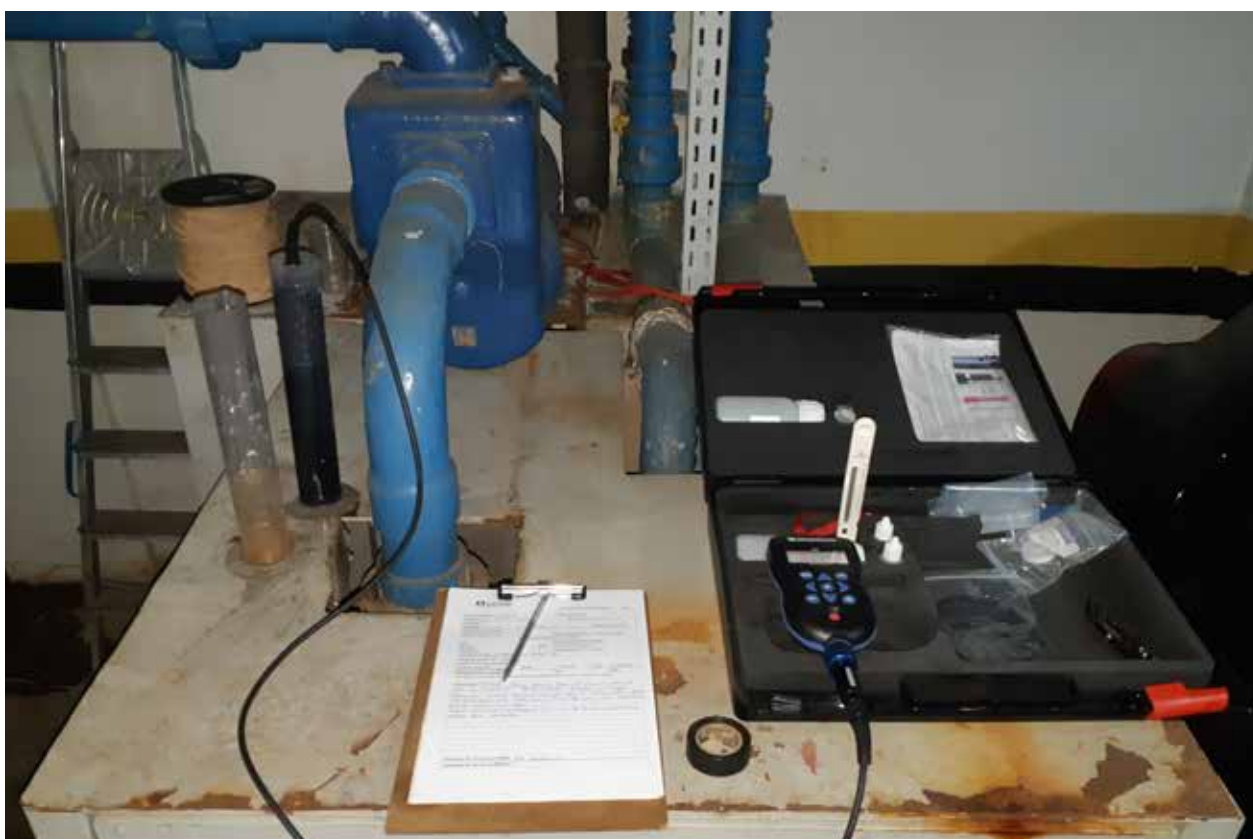
Figura 3.2. Medição em campo dos parâmetros pH, Eh, CE e temperatura da água durante a coleta das amostras.
