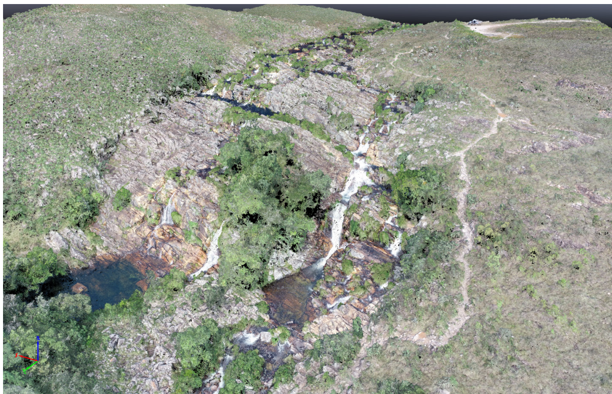
Figura 88 - Cachoeira Rasga Canga. Restituição digital de modelo de terreno a partir de levantamento de drone.
