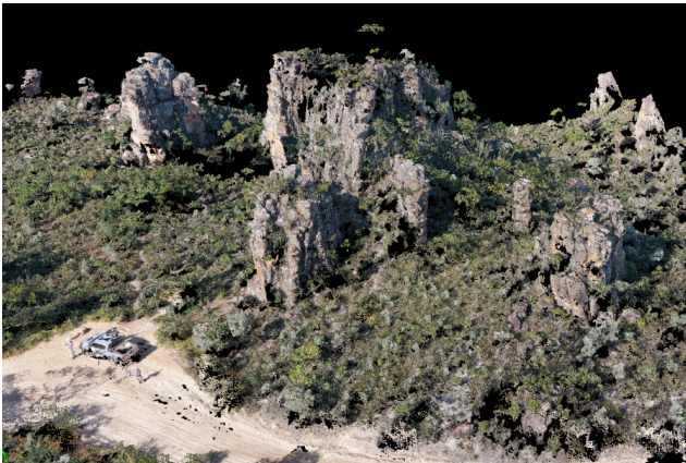
Figura 66 - Restituição 3D dos blocos rochosos, onde se observa o grau fraturamento e as fraturas subverticais. Fonte: Foto dos autores.
