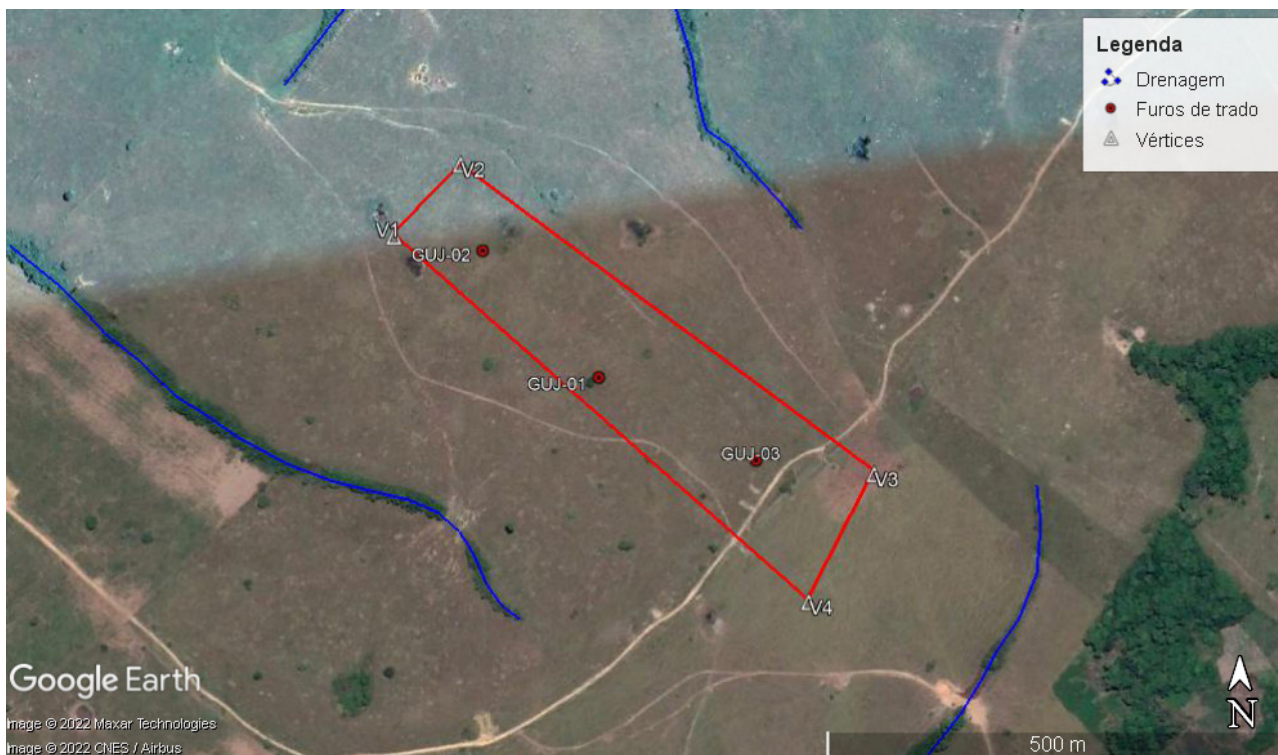
Figura 6 - Imagem de satélite de alta resolução (julho/2019) com a situação em detalhe da área de 7,5 ha avaliada para implantação do aterro sanitário de Guajará, com a localização dos três furos de trado realizados e das drenagens mais próximas. Os pontos V1 a V4 são os vértices da área, cujas coordenadas geográficas estão informadas na Tabela 2. Fonte: Google, c2022.
