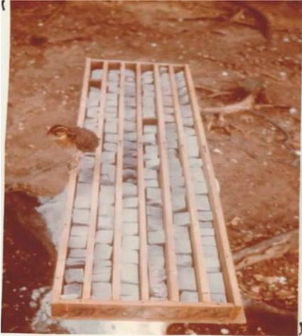
**Figura 9** - Forma de acondicionamento de testemunhos de sondagem, no caso um testemunho fragmentado relativo ao furo AV-45-PA. Fonte: Companhia de Pesquisa de Recursos Minerais (1979a, 1979b).
