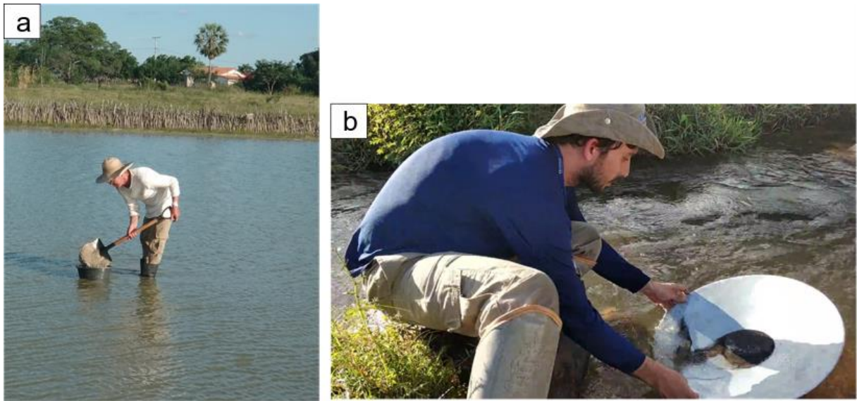
Figura 1.7. Amostragem mostrando em a) a coleta de amostra de concentrado de minerais pesados e b) concentração do minerais pesados em bateia.
