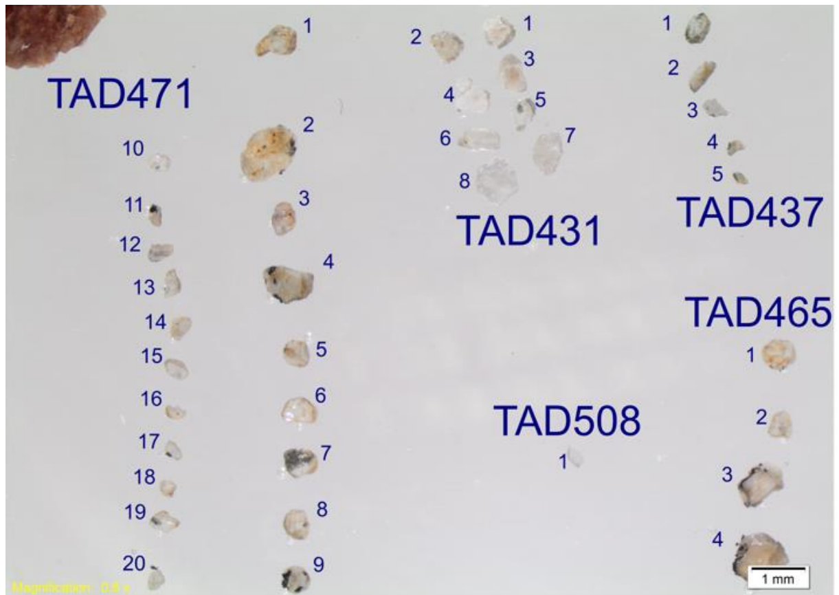
Figura 2. Mount de apatitas aluvionares das amostras TAD471, TAD431, TAD508, TAD437 e TAD465.
