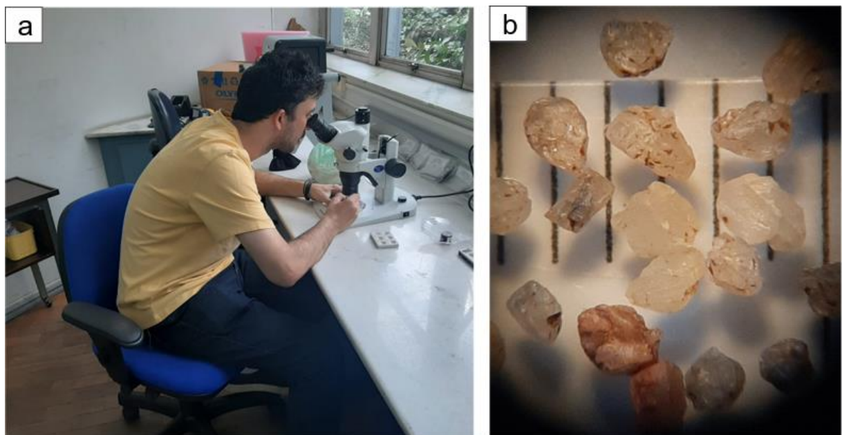
Figura 1.10. Reanálise dos concentrados de minerais pesados mostrando a) catação manual e b) grãos de apatita encontrados nas amostras reanalisadas.
