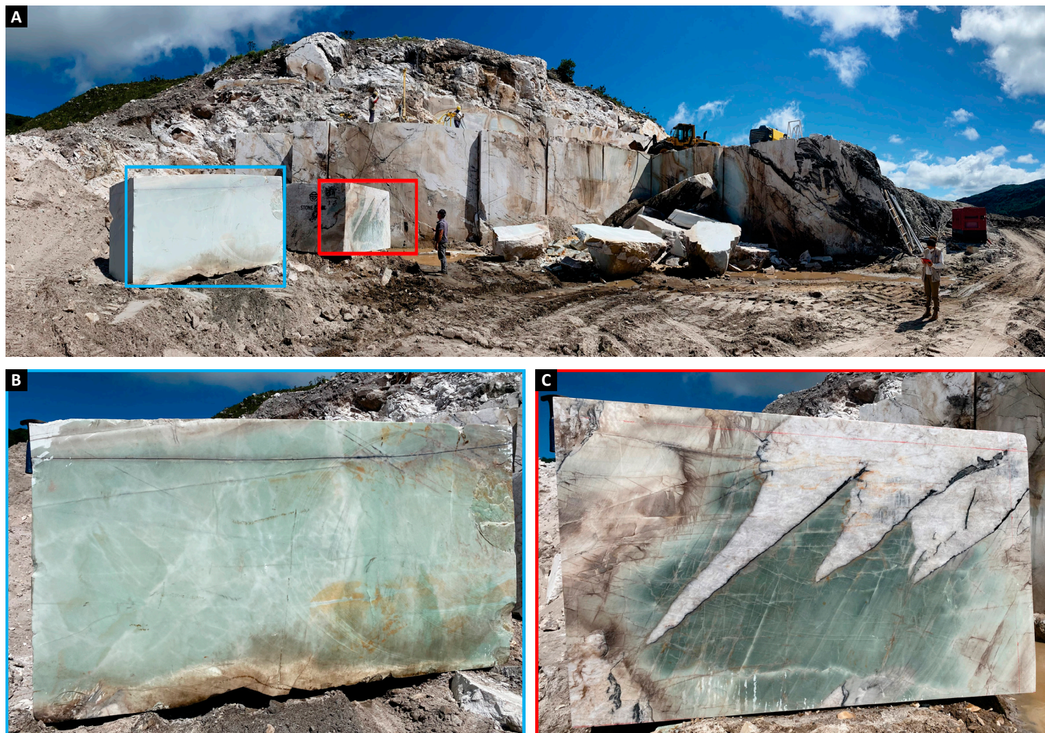
Figura 4.10 - Frente de lavra de quartzito com feições esverdeadas feições esverdeadas (fuchsitita) e brancas (quartzito branco e translúcido), localizada em Pindobaçu. (A) Frente de lavra principal com blocos extraídos; (B) Bloco de fuchsitita quartzito; (C) Bloco de fuchsitita quartzito com quartzito branco.
