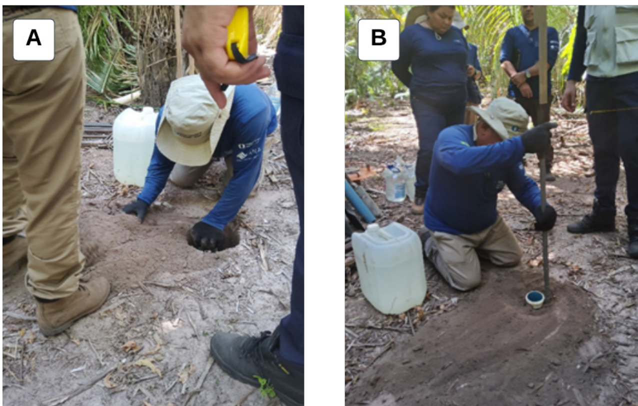
Figura 06 - Teste de condutividade; (A) adicionar água no furo até sua estabilização, (B) medir e anotar o valor do rebaixamento do nível da água no furo. Fonte: os autores.
