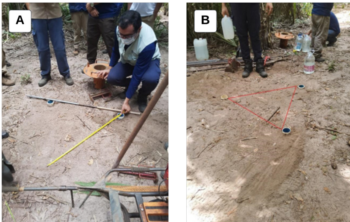
Figura 04 - Preparação dos furos para o teste de condutividade hidráulica. (A) Medir a distância de 1 metro entre os três furos de sondagens. (B) Furos já executados, formando um triângulo equilátero de lados congruentes de 1,0 metro. Fonte: os autores.
