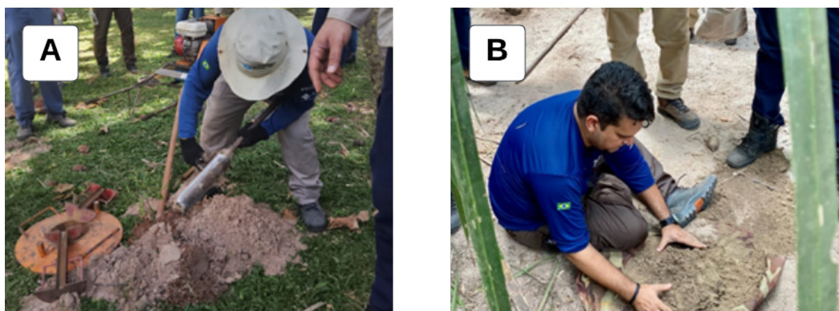
Figura 08 - Procedimento para a coleta da amostra de solos: (A) retirada da amostra do furo; (B) misturando os solos para uma homogeneização da amostra. Fonte: os autores.
