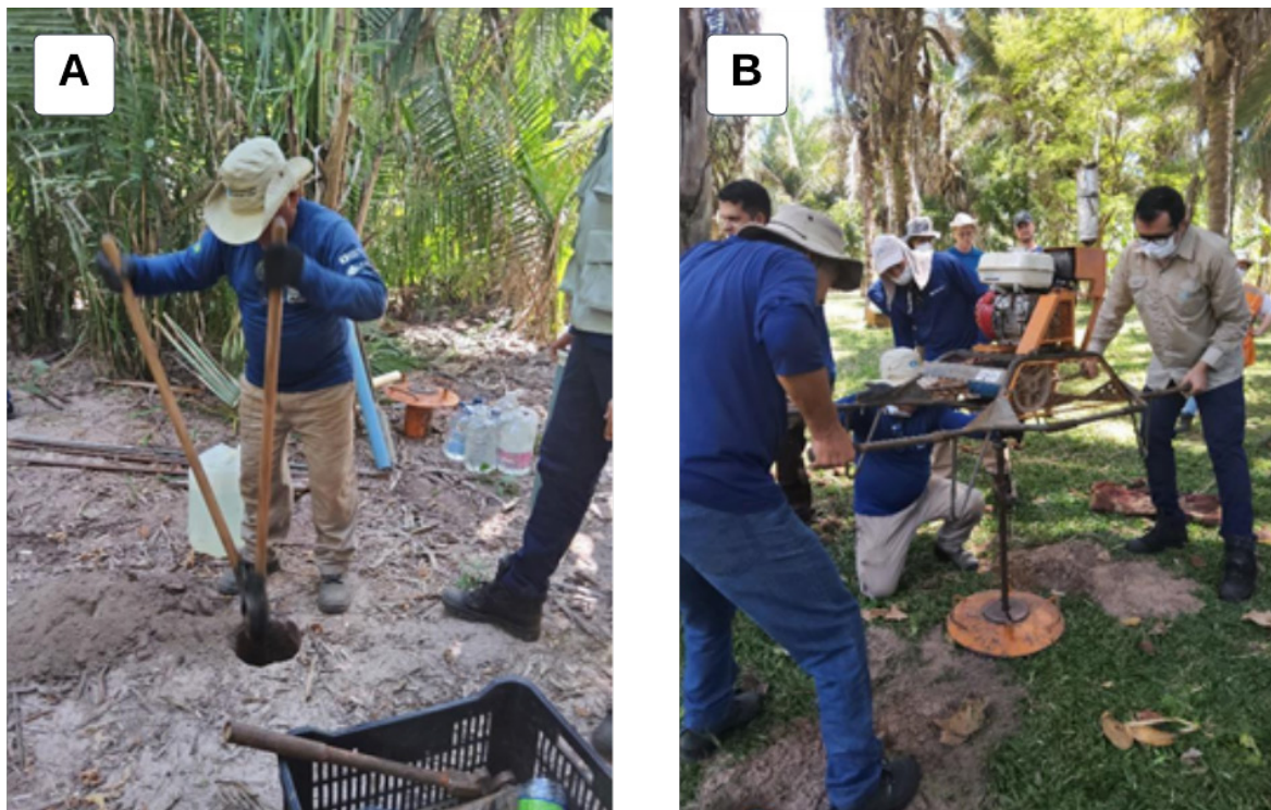
Figura 03 - Instalação do trado. A) utilizando cavador para abrir um buraco de aproximadamente 10 cm para a instalação do trado. B) Trado motorizado sendo instalado. Fonte: os autores.
