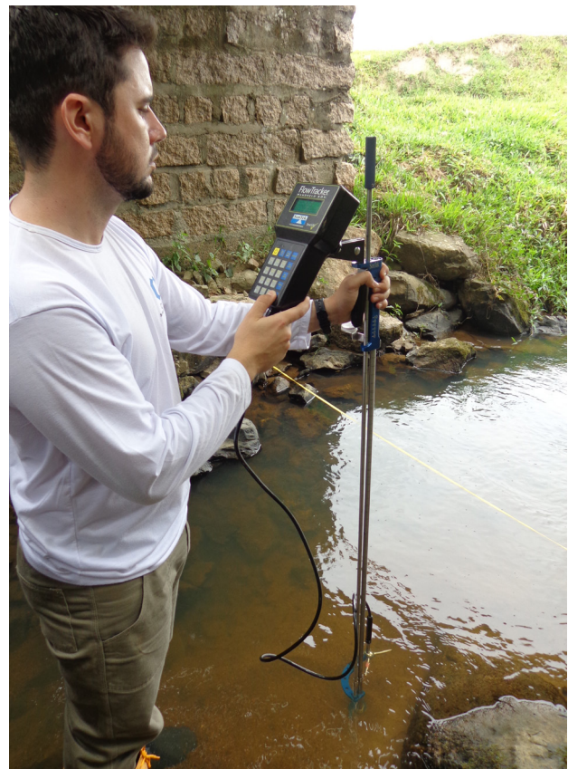
Figura 33 - Medidor de vazão acoplado a haste do micromolinete. Fonte: acervo do projeto.
