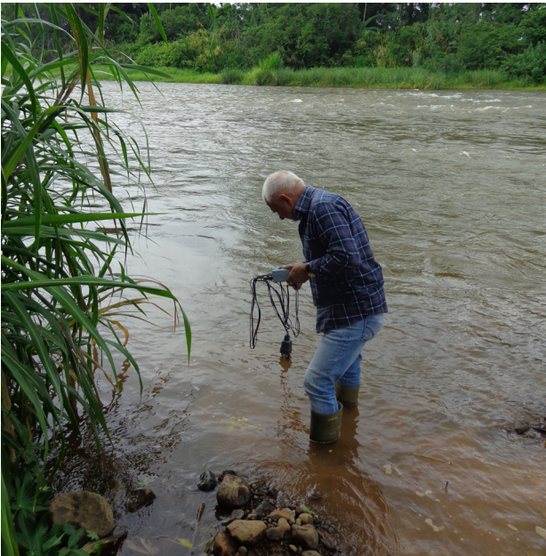
Figura 32 - Medição de qualidade da água in situ . Fonte: acervo do projeto.
