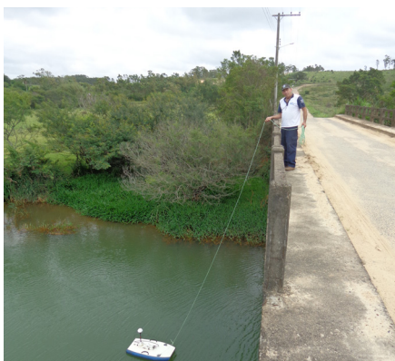
Figura 36 - Medição de vazão por ADCP. Ponto EV-S-011, Canal Urussanga. Fonte: acervo do projeto.
