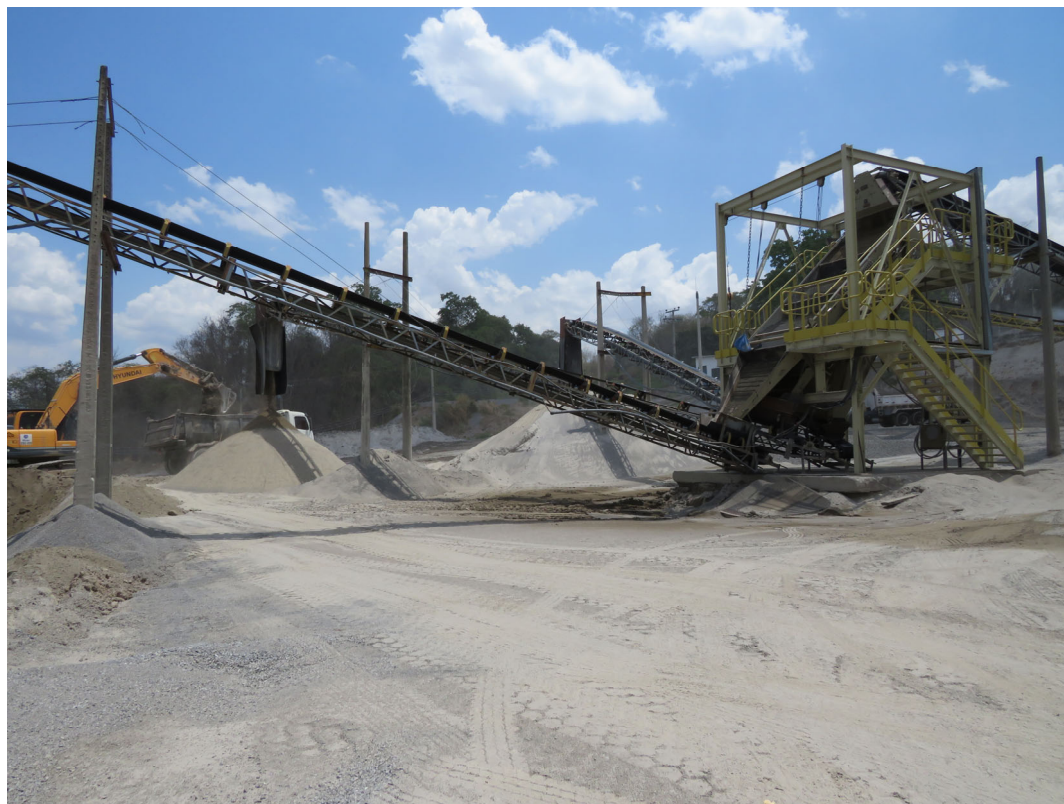
Classificação a seco por peneira vibratória. Lavra Briteng, Bela Vista de Goiás.
