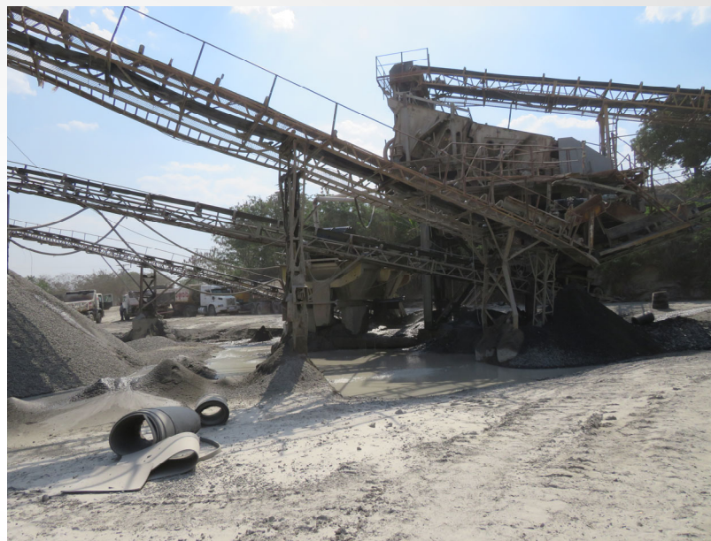
2021: Obtenção de finos de britagem através da lavagem de areia de brita
