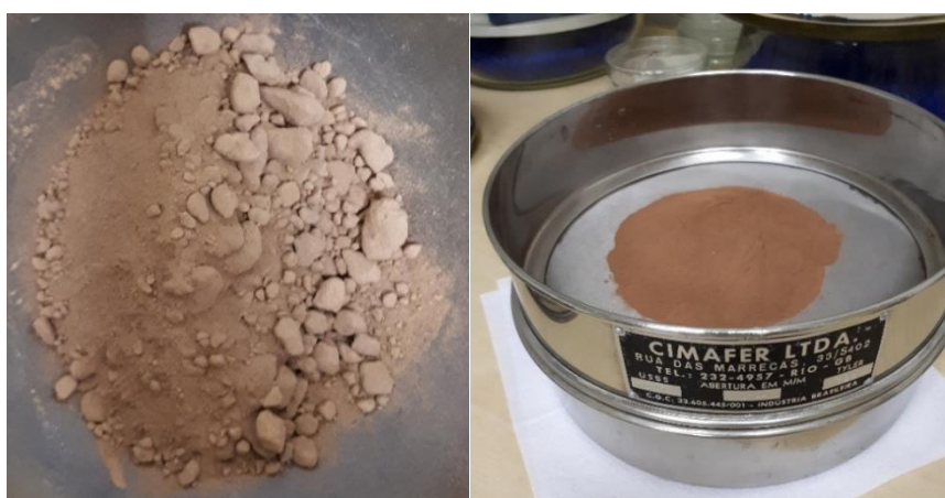
FIG. 3.3 Mistura de pós após secagem a vácuo (esquerda) e ao ser levada a peneira (direita).
