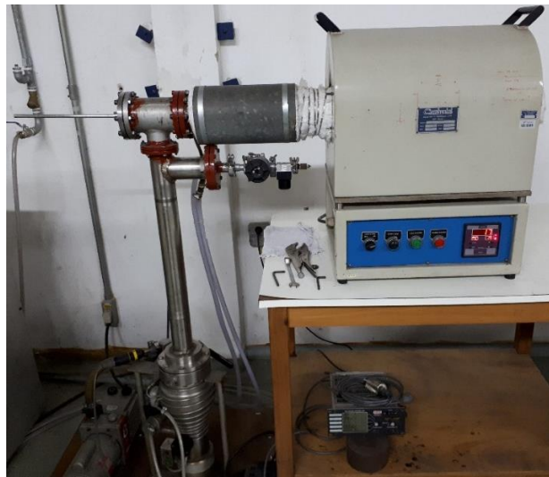
FIG. 3.5 Forno resistivo utilizado nas sinterizações da etapa de otimização dos parâmetros do processo de fabricação dos compósitos.
