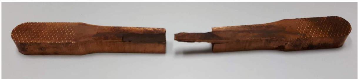
FIG. 8.3 Corpo de prova fragilizado devido a oxidação e com presença de uma fissura concentradora de tensão.
