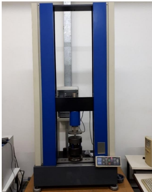
FIG. 3.4 Máquina de Ensaio EMIC utilizada para compactação da mistura de pós.
