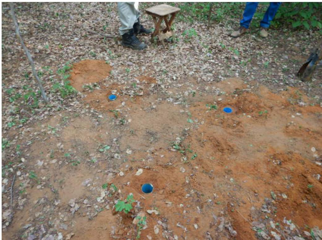
**Figura 3.6** - Execução do teste de infiltração no FT-03. Foto: acervo dos autores.
