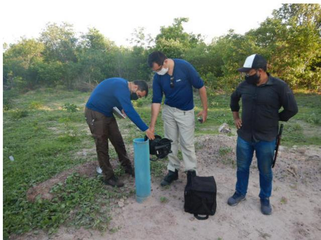
**Figura 3.4** - Medição do nível estático em poço tubular.
