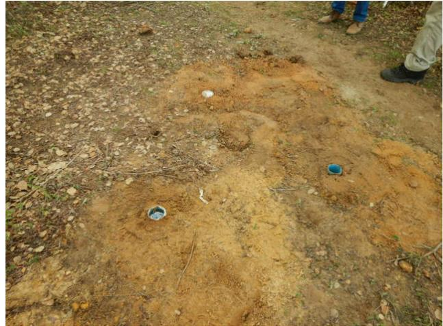
**Figura 3.3** - Furos de 0,5 m, 1,0 m e 1,5 m revestidos com tubos de PVC com 75 mm de diâmetro, para serem executados os testes de infiltração.
