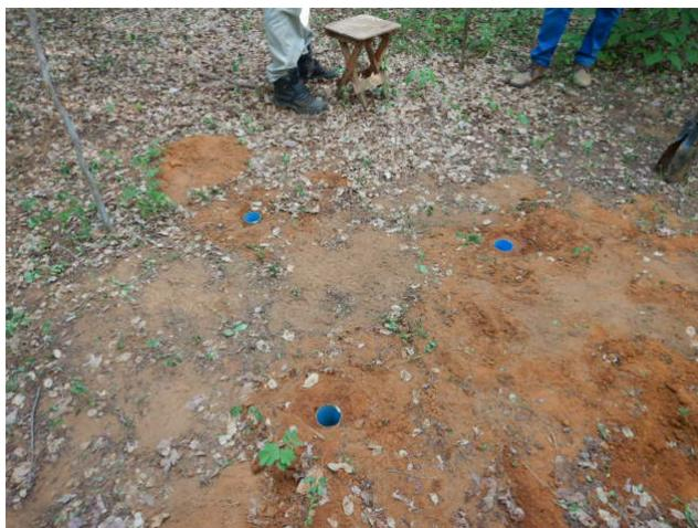
**Figura 3.5** - Furos de 0,5 m, 1,0 m e 1,5 m revestidos com tubos de PVC com 75 mm de diâmetro, para serem executados os testes de infiltração.
