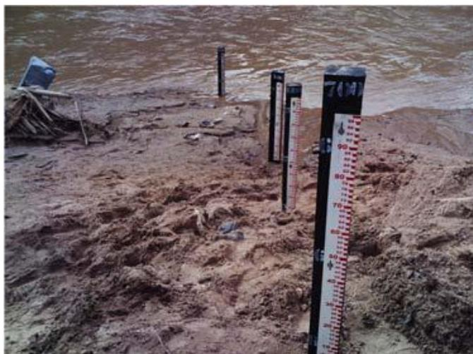
Figura 16 - Réguas da estação fluviométrica de Santana do Mundaú recuperadas após a cheia de junho de 2010 (CPRM, 2010).
