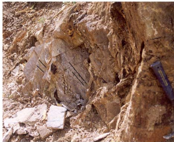
Foto 6.6 - Gnaiss milonitizado com indicação da lineação de estiramento (traços pretos). S:180/70-L:140/65 (Complexo Piracaia, afl. 198, estrada Itajubá-Delfim Moreira, visada para N).
