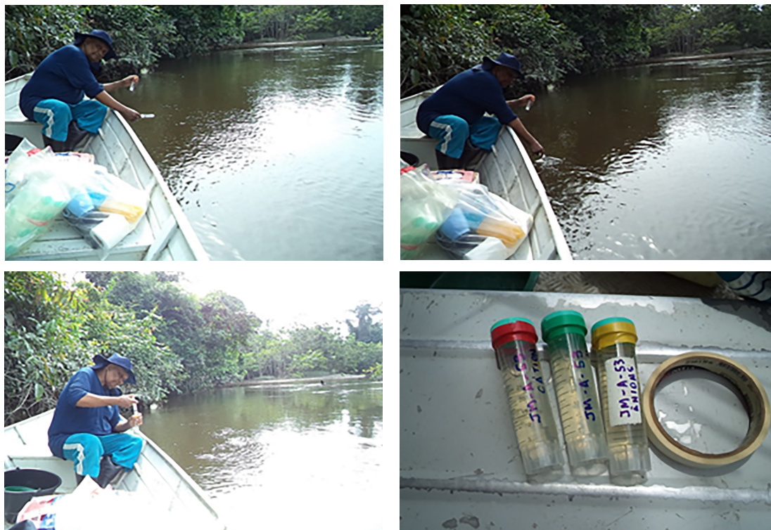
Figura 5 - Aspectos da coleta e filtragem de amostras de água coletadas no ponto JM-42 (igarapé Marié-Mirim) e vista das três alíquotas de 50ml coletadas em cada ponto.
