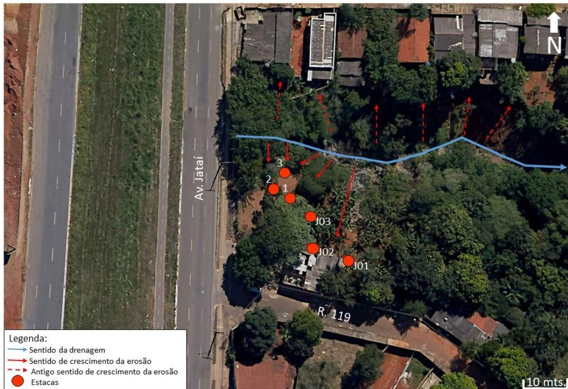
Figura 54 - Posicionamento das estacas na erosão 12 (Avenida Jataí), com destaque para seu sentido de crescimento
