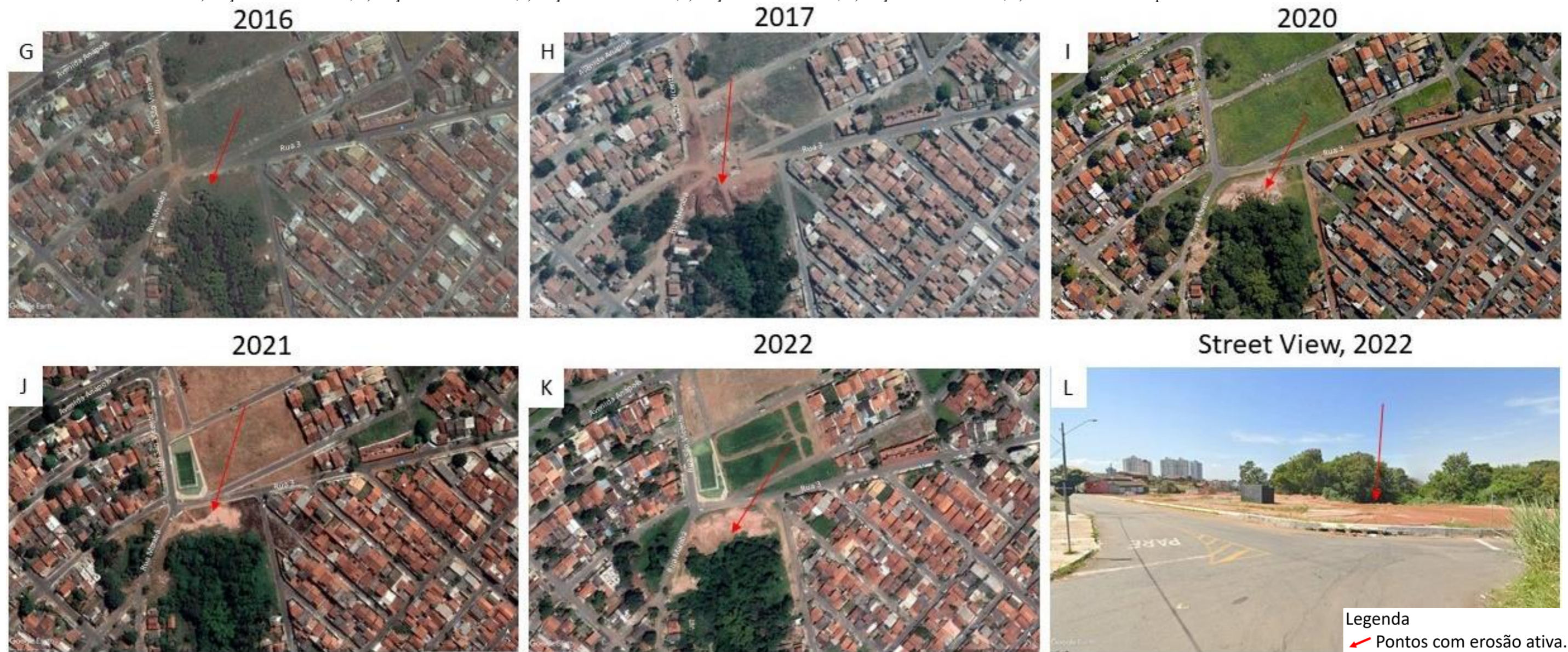
Figura 26 - Análise da evolução temporal da feição erosiva denominada 19 por Ferreira de Oliveira (2005) e 15 por Fernandes et al. (2017) G) Feição erosiva em 2016; H) Feição erosiva em 2017; I) Feição erosiva em 2020; J) Feição erosiva em 2021; K) Feição erosiva em 2022; L) Foto de uma das ruas próximas à erosão no ano de 2022
