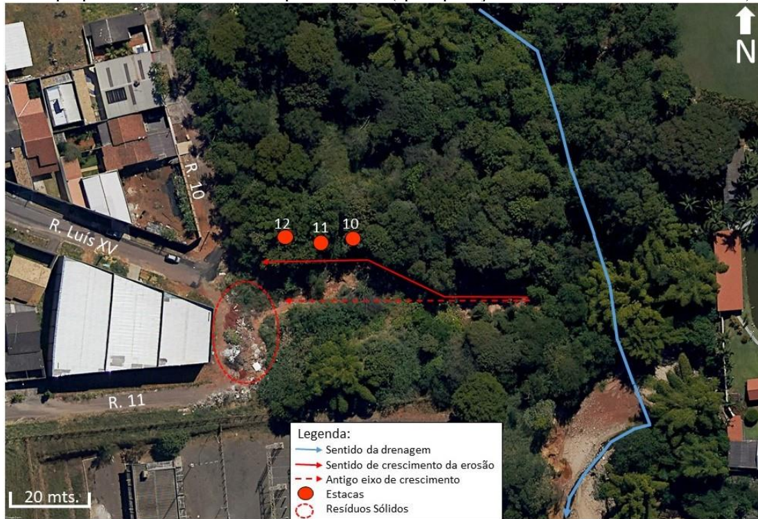
Figura 43 - Posicionamento das estacas de monitoramento na erosão 02 (Rua Luís XV versus Rua 10), com destaque para o eixo de crescimento prévio e atual (após aplicação de técnica de controle da erosão)
