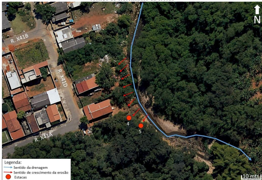
Figura 49 - Posicionamento das estacas de monitoramento na Erosão 08 (Rua X41D), com destaque para o sentido de crescimento da erosão
