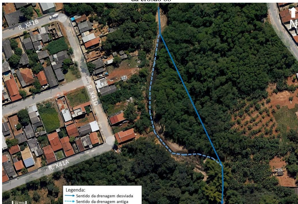
Figura 51 - Esquema ilustrativo da obra de desvio do Córrego Almeida, com o objetivo de evitar o crescimento da erosão 08
