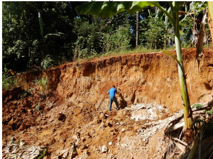
Figura 57 - Parede da erosão a partir da qual foram realizadas a identificação e a análise tátil-visual dos materiais geológicos
