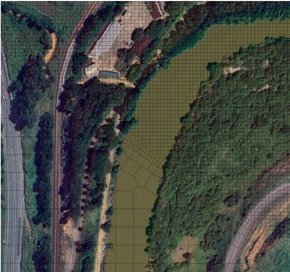
Figura 21 – Exemplo de transição da malha 25x25 para a malha 5x5
