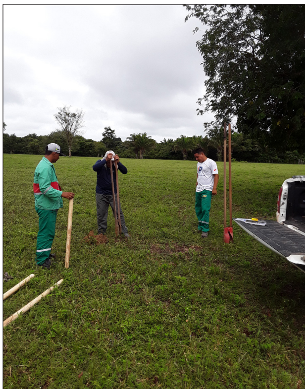
Figura 8 - Execução de furo de trado na área 6. Foto: acervo dos autores.
