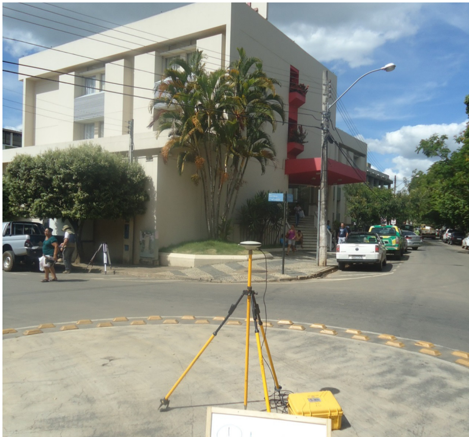
Figura 67 - Receptor GPS para obtenção de dados planialtimétrico Local: Bairro Centro
