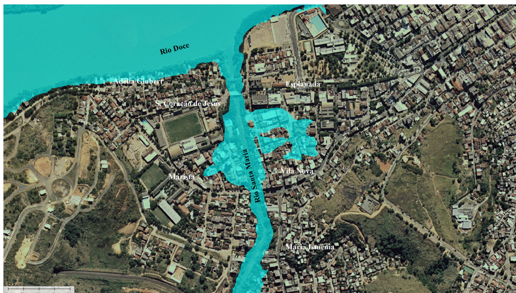
Figura 29 - Exemplo de mapeamento de inundação da margem direita do rio Doce e margens do rio Santa Maria, para a cota de 750 cm
