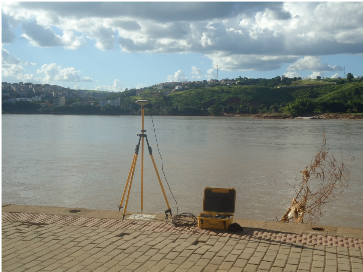
Figura 69 - Ocupação de Rn por receptor GPS para nivelamento da estação fluviométrica Local: Bairro Esplanada
