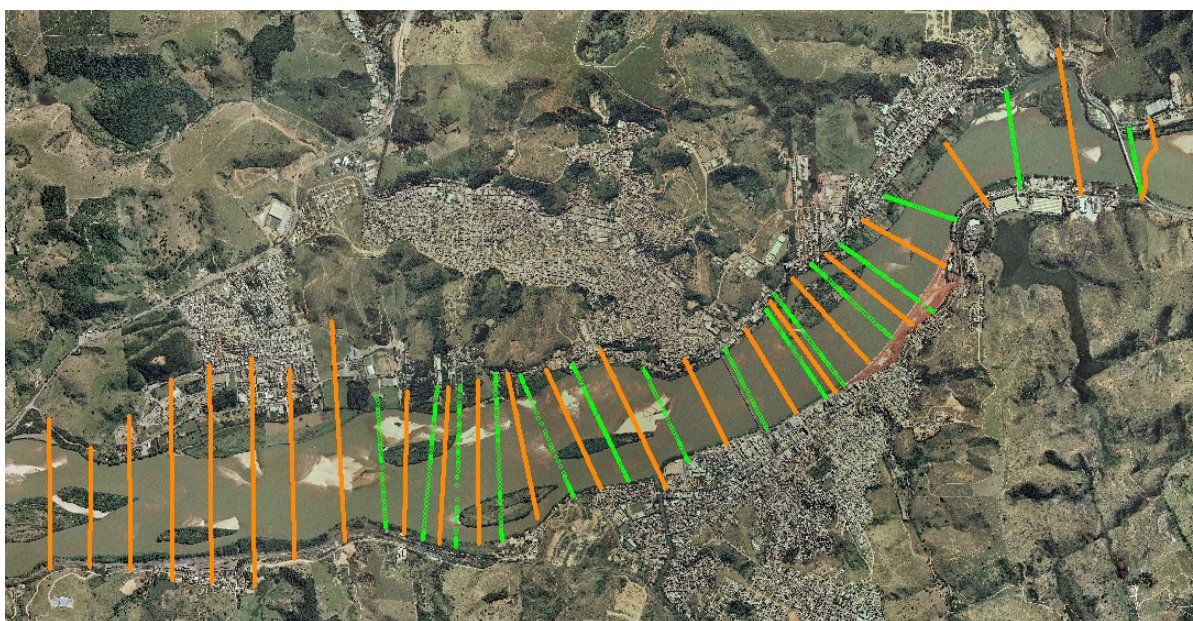
Figura 25 - Localização das seções topobatimétricas do rio Doce, utilizadas no modelo hidráulico
