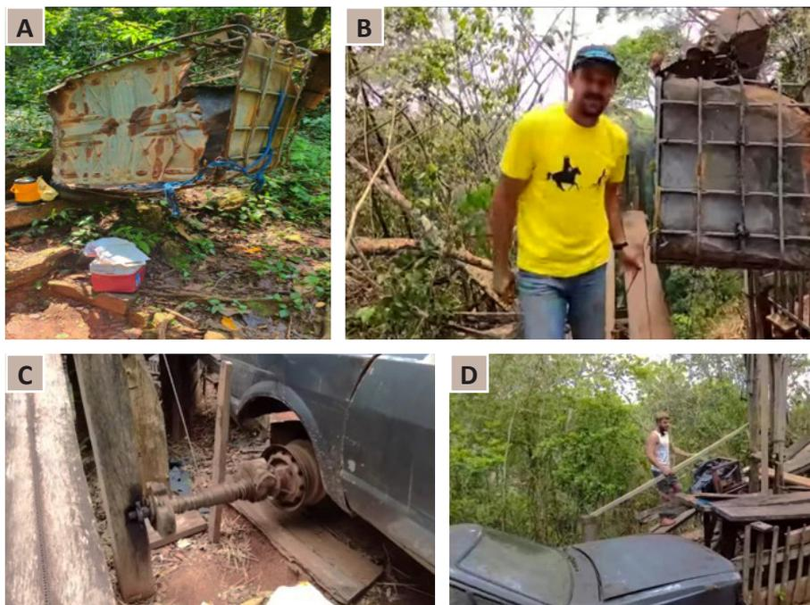
**Figura 17** - (A) Bondinho utilizado para descer *coolers* e bolsas dos visitantes; (B) Sr. Ratunde ao lado do bondinho; (C) Cabo de aço do bondinho ligado ao eixo da roda do carro; (D) Vista geral da engenhoca criada pelo sr. Ratunde. Fonte: Elaborado pelos autores.
