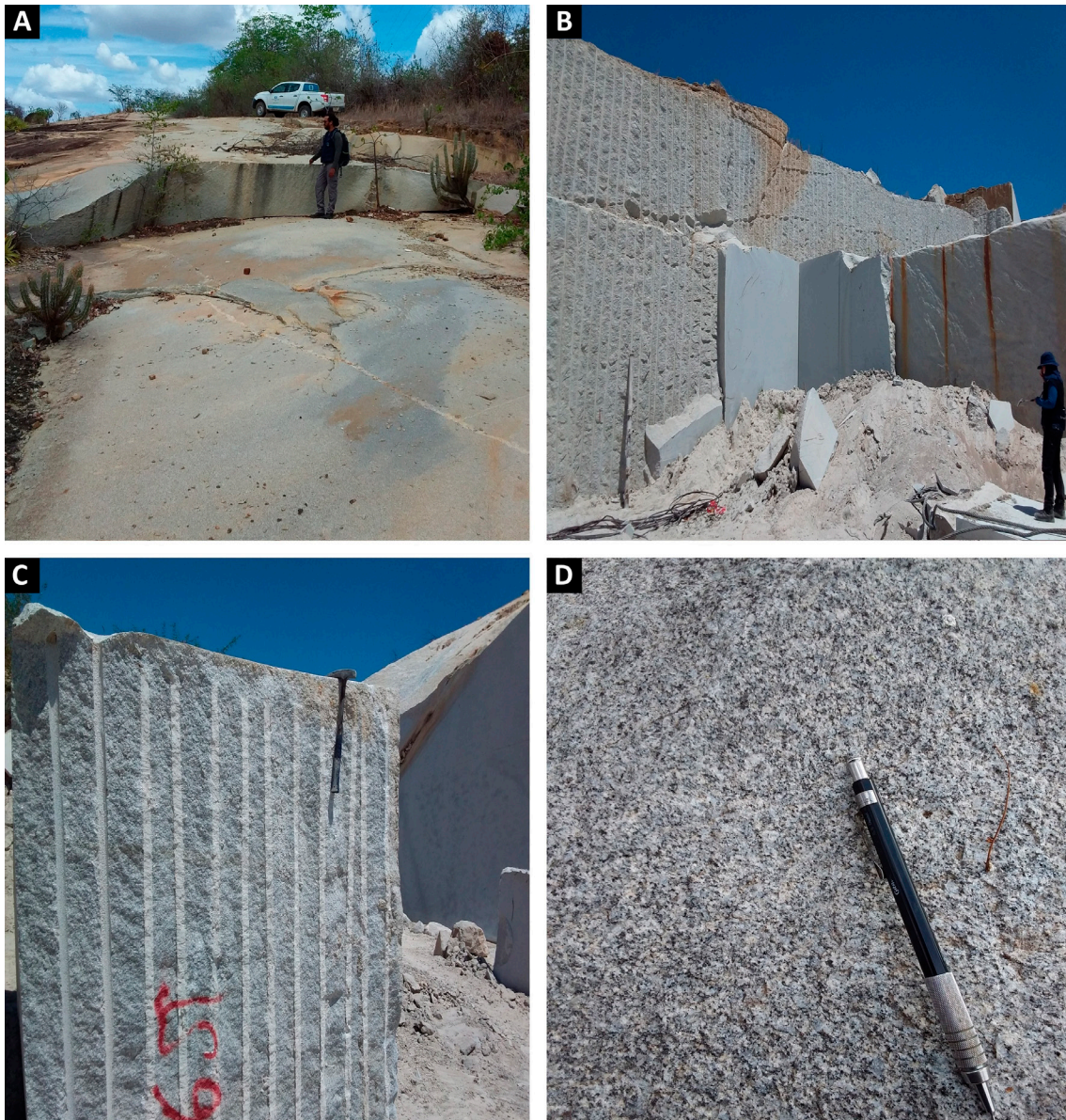
Figura 6.24 - A) Maciço do Branco Banabuiú (IB142); B) Frente de lavra ativa da Suíte Banabuiú; C) Bloco do tipo comercial Ouro Branco (AF34); D) Granito leucocrático isotrópico da Suíte Piquet Carneiro, semelhante ao tipo comercial Cinza Andorinha - ES (MD33).
