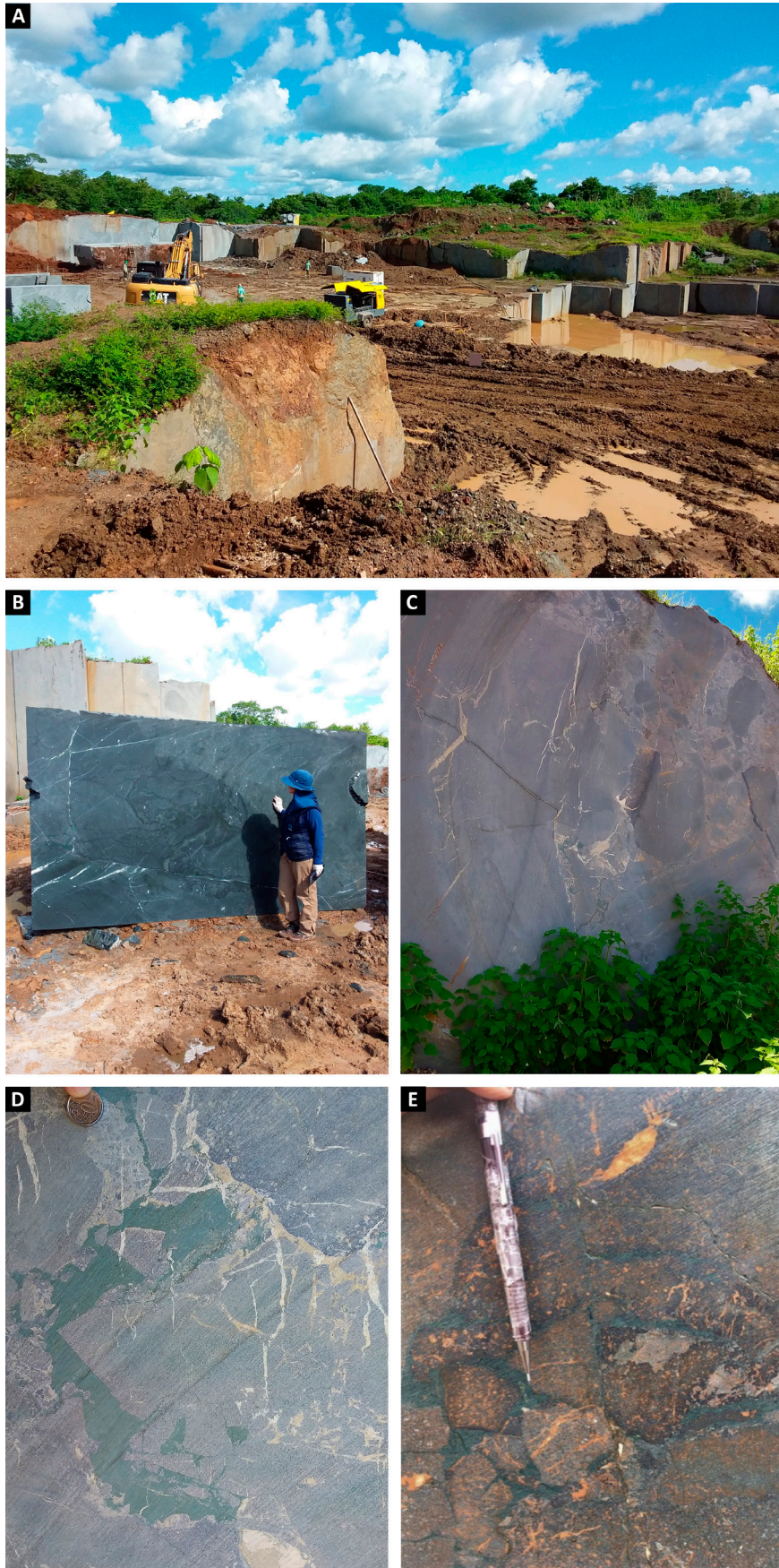
Figura 6.8 - A) Lavra em Massapê das variedades comerciais Negresco e Infinity (MD06); B) Bloco do basalto Negresco; C) Corte em matacão da brecha hidrotermal comercializada como Infinity; D) Detalhe do intenso fraturamento preenchido por clorita e carbonato, E) Variação designada Kourus (MD06C). Fonte: arquivo de campo do projeto.
