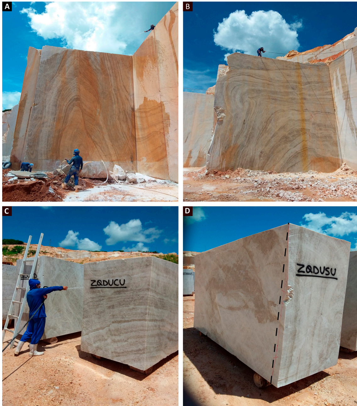
Figura 6.5 - A e B) Lavra do quartzito Matira, próximo à cidade de Campanário, com bancadas consecutivas, apresentando grande dobramento; C e D) Bloco pronto para comercialização e com fraturas condicionantes de ajustes do tamanho final do bloco (AF117). Fonte: arquivo de campo do projeto. Empresa Thorgranitos.
