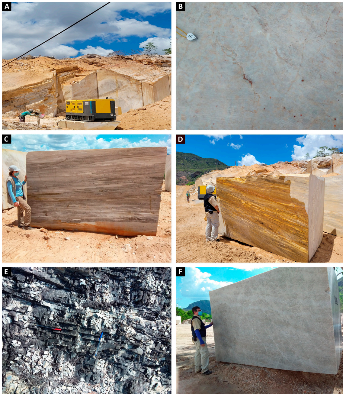
Figura 6.3 - A) Frente de lavra utilizando corte a fio diamantado (AF87); B) Quartzito Ellegance de aspecto maciço (AF86); C e D) Quartzito Waya com arranjo comercialmente denominado de movimentado e Quartzito Guará de coloração cinza a amarelo, ambos de uma mesma jazida (AF87), Município de Granja; E e F) relações angulares das direções principais de fraturamento e bloco finalizado do Perla Chiara com o fraturamento preenchido por sericita e, localmente, por turmalina e opacos (AF89).
