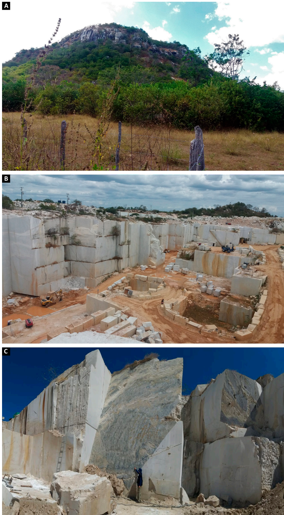
Figura 6.15 - A) Forma de ocorrência dos corpos graníticos da Suíte Taperuaba; B) Jazida estruturada em bancadas múltiplas do Branco Ceará e Branco Cotton (IB23); e C) Exemplo de zona de falha como fator restritivo ao avanço da frente de lavra. Fonte: arquivo de campo do projeto.
