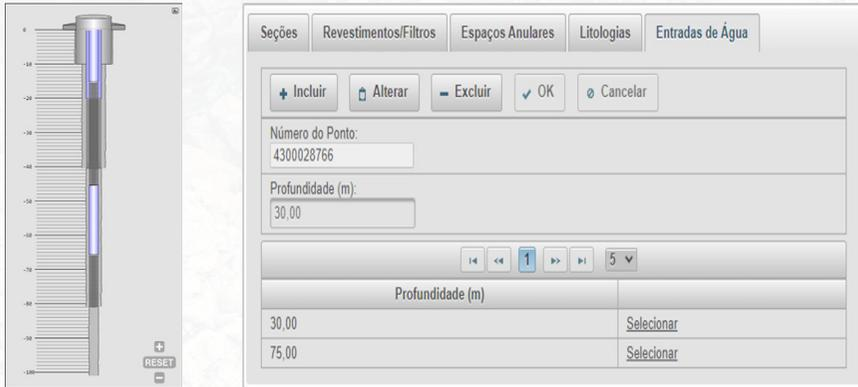
FIGURA 54 A: RESULTADO DE IMAGEM PLC GERADA COM OS DADOS DE SEÇÕES DE PERFURAÇÃO, DE TUBULÃO, DE REVESTIMENTO, DE FILTRO, DE DUAS SEÇÕES DE ENCAMISAMENTO E DE DUAS SEÇÕES DE FILTRO-ENCAMISAMENTO. / FIGURA 54 B: ALIMENTAÇÃO DE DADOS DE ENTRADAS DE ÁGUA.
