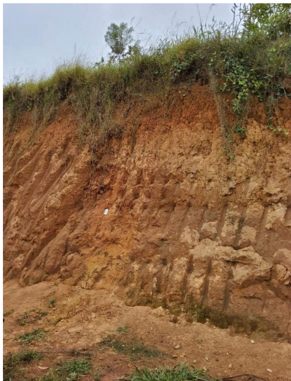
Figura 28: Ponto de campo número 9 – Solo residual de dique de rocha básica. UTME: 671443, UTMN: 7212509 - Rio Branco do Sul – PR
