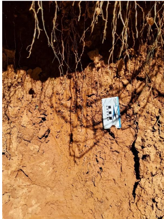
Figura 15: Ponto de campo número 36 – Perfil de solo residual de mármore, coordenadas UTME: 671713, UTMN: 7209524 – Rio Branco do Sul – PR.
