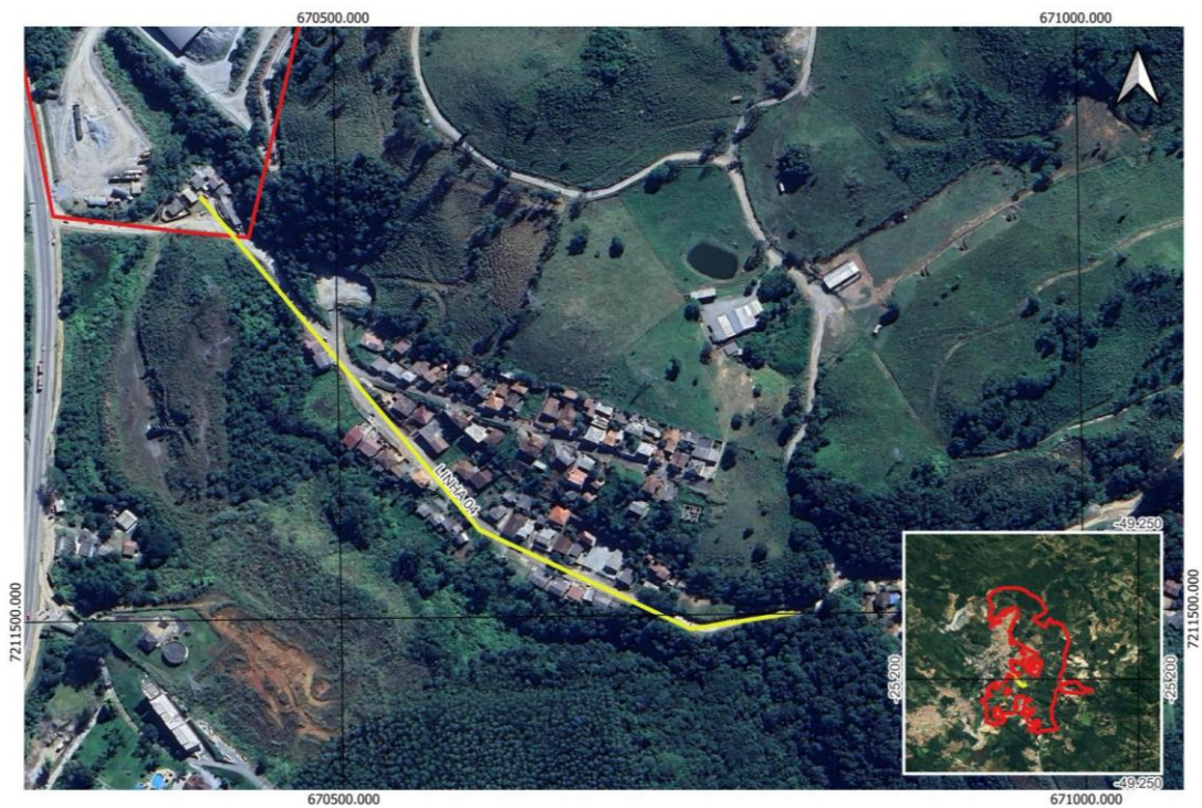
Figura 16: Localização do perfil de caminhamento elétrico da linha 4 (linha amarela). Margem da Rua Antônio Artigas de Miranda – Rio Branco do Sul – PR. (A linha vermelha é o limite da área de expansão).
