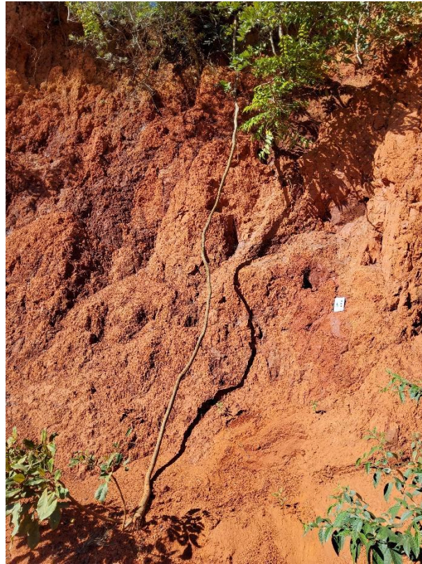
Figura 6: Ponto de campo número 44 - Solo residual de calcarenito: argila siltosa pouco arenosa, plástica, marrom avermelhada. Coordenadas UTME: 669571, UTMN: 7214653 - Rio Branco do Sul – PR.
