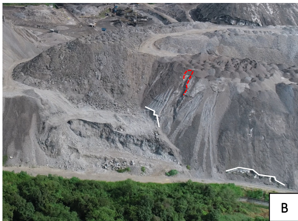
Figura 11 – Feições em talude voltado para o Rio Paraíba do Sul. A) Mapa de feições de instabilidade #3: taludes voltados ao Rio Paraíba do Sul. B) Vista aérea por RPA: movimento translacional raso associado a feições erosivas. C) Vista aérea por RPA: destaque (seta amarela) das feições erosivas e do deslizamento translacional raso na interface de um corte no terço inferior do talude.
