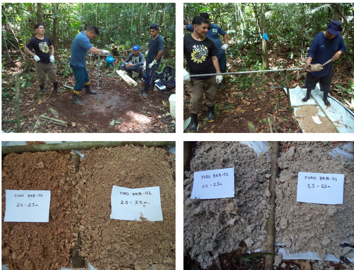
Figura 8 - Aspectos da perfuração, retirada do material do trado e de dois intervalos de solo/subsolo atravessados pelo furo BRB-01.
