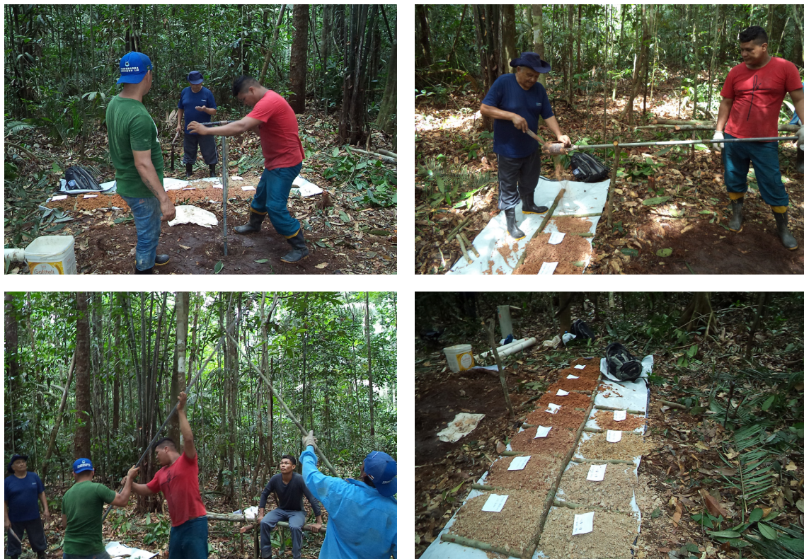
Figura 9 - Aspectos da perfuração e de todo o perfil de solo/subsolo atravessado pelo furo BRB-02.
