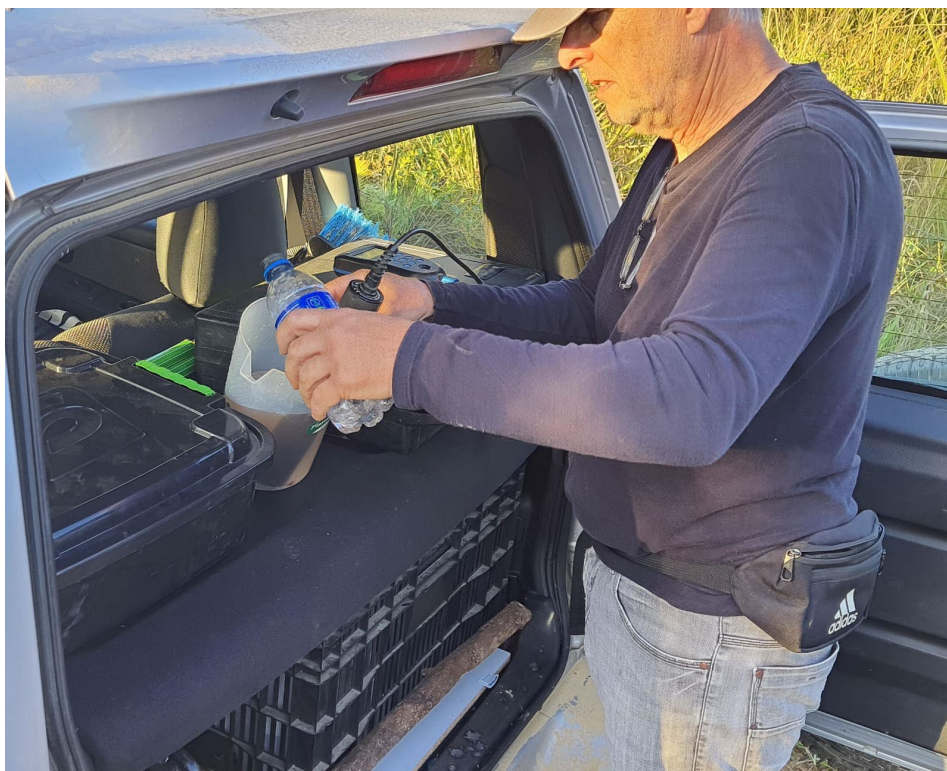
Figura 25 Medição in loco dos parâmetros físico-químicos com sonda multiparamétrica.
