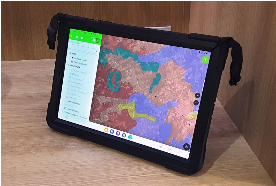
Figura 22 Tablet com aplicativo cadastramento de pontos de água subterrânea no QField.
