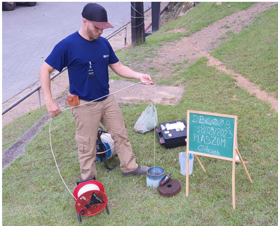
Figura 24 Medição de nível d'água em poço tubular (nível estático) com medidor eletrônico Solinst.
