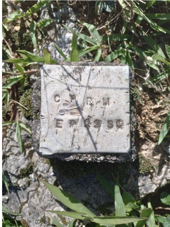
Figura 6 Detalhe da placa de identificação da sondagem para pesquisa de carvão mineral.
