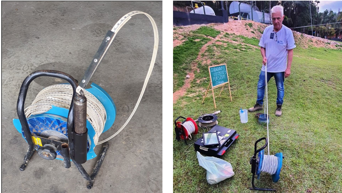
Figura 23 Corpo de prova e seu uso para medir profundidade de poço tubular em Orleans.
