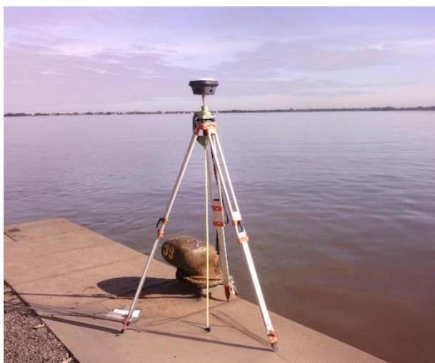
Figura 16: Levantamento com GPS no RN de apoio na cobertina do portão principal da SPH-RS.
