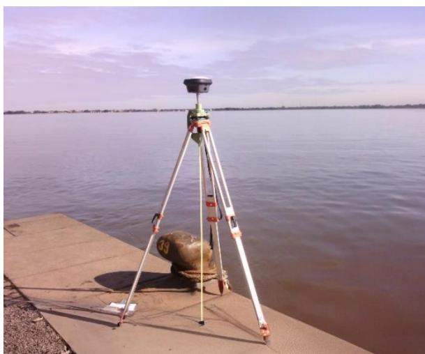
Figura 16: Levantamento com GPS no RN de apoio na cobertura do portão principal da SPH-RS.
