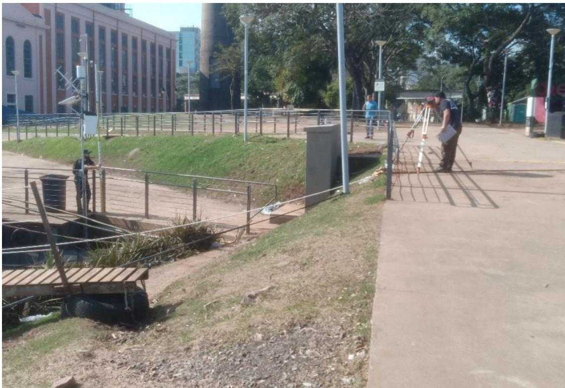
Figura 15: Nivelamento geométrico junto da estação Usina do Gasômetro.
