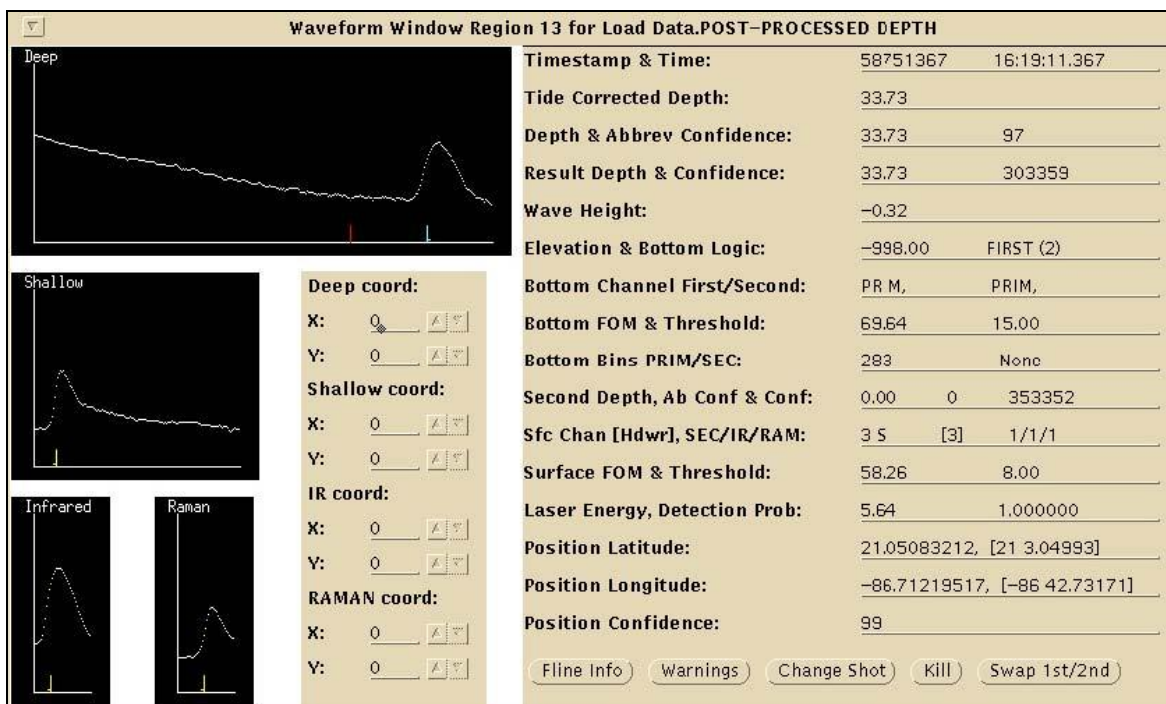
Figura 6 – A janela da forma de onda SHOALS está disponível para cada pulso laser; ela contém as formas de onda de todos os quatro canais receptores e os valores dos parâmetros chave.
