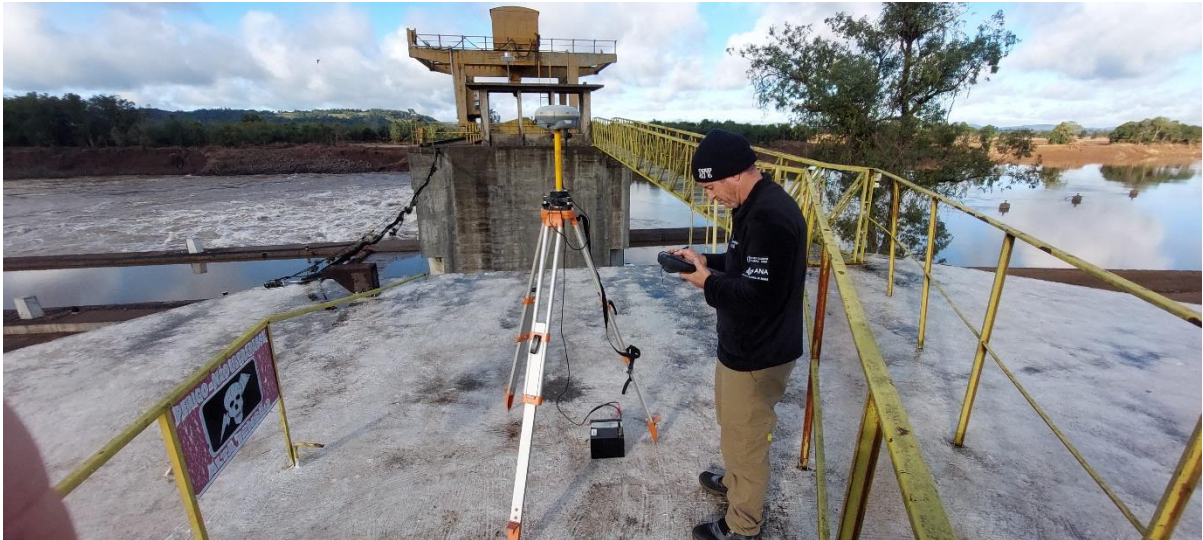
Figura 3. Levantamento com GPS-RTK na estrutura da eclusa de Bom Retiro do Sul.
