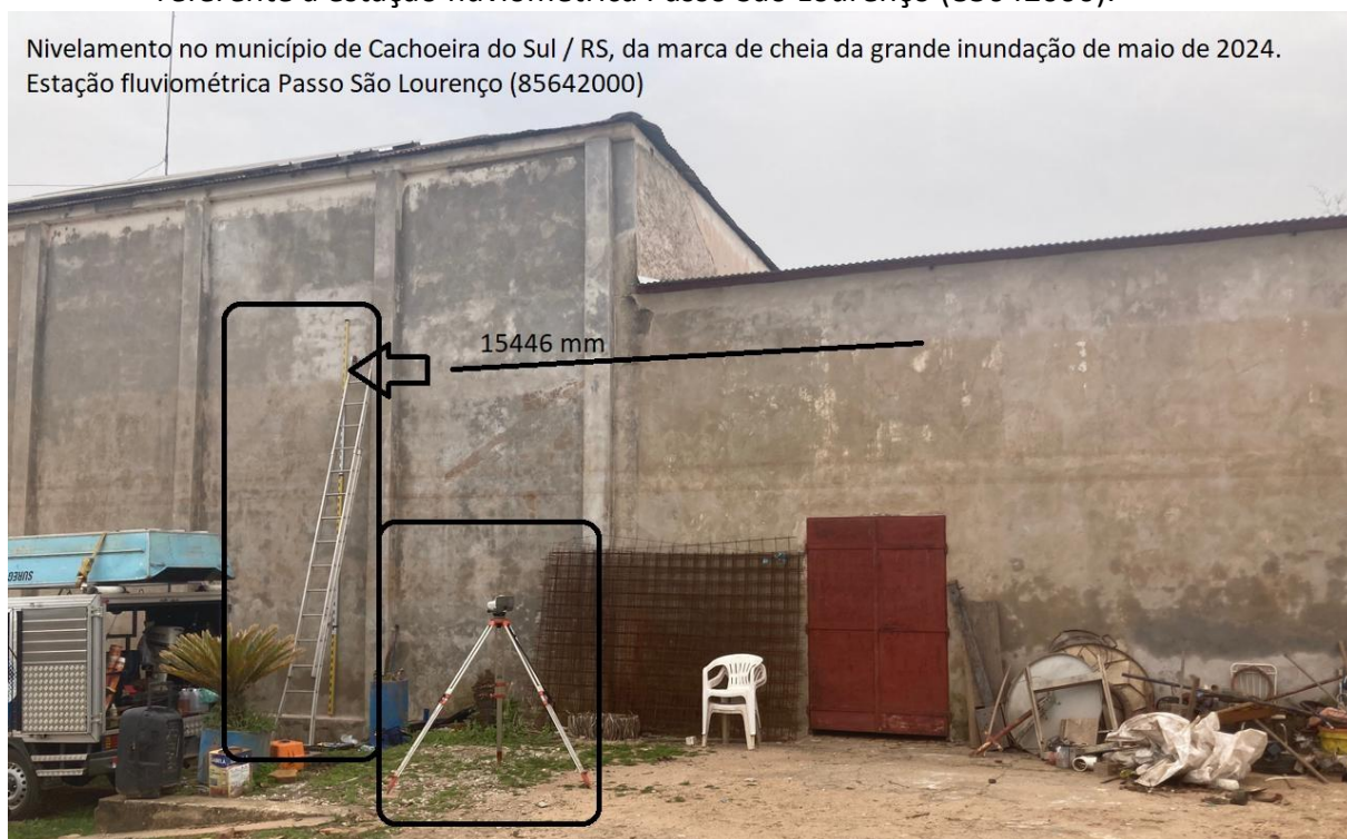
Figura 12. Marca de cheia nivelada do rio Jacuí, no município de Cachoeira do Sul / RS, referente a estação fluviométrica Passo São Lourenço (85642000).
