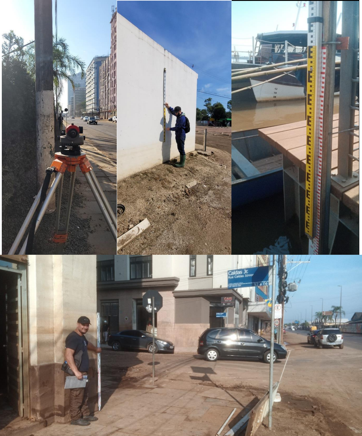
Figura 14. Trabalho de levantamento das marcas de cheia niveladas do rio Jacuí, na capital Porto Alegre / RS, referente as estações fluviométricas Caís Mauá C6 e Usina do Gasômetro.
