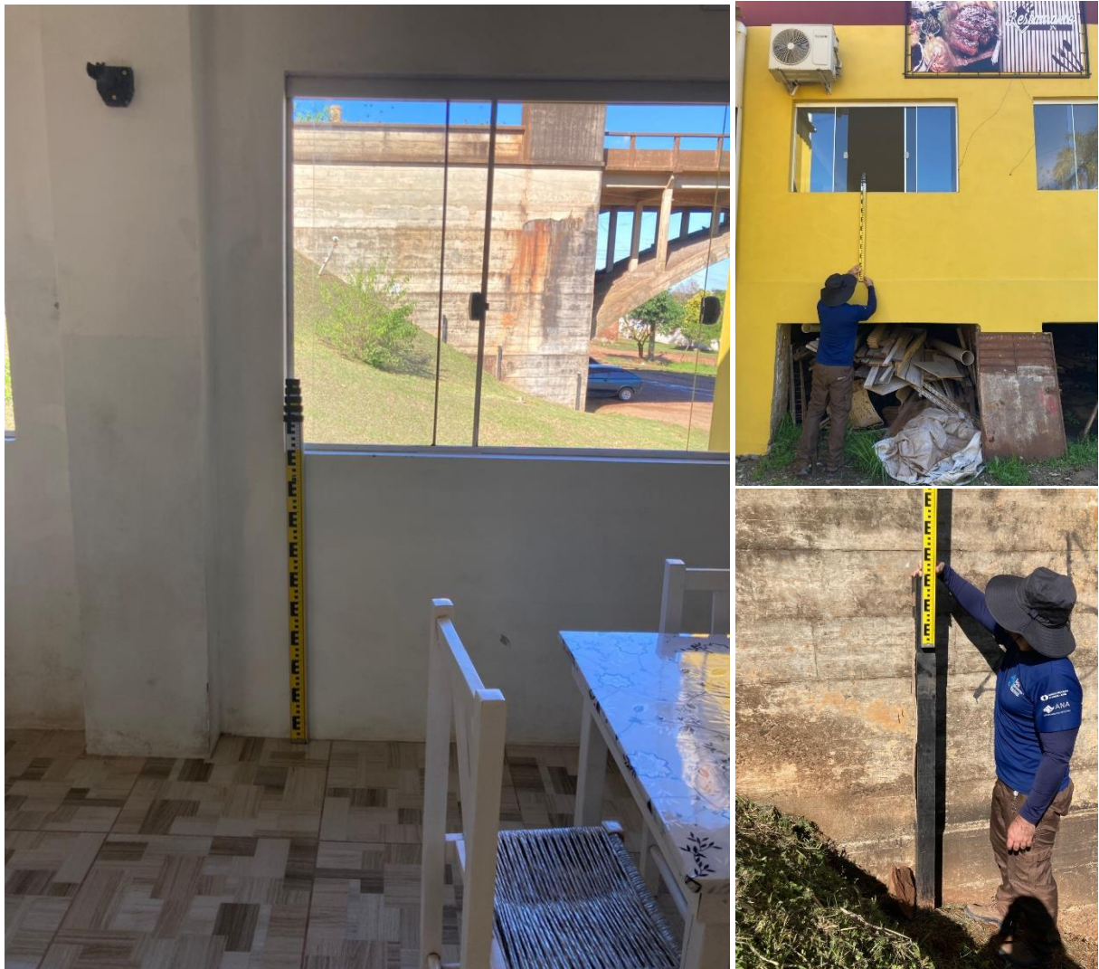
Figura 11. Marca de cheia nivelada do rio Ibicuí, no município de Manoel Viana / RS, referente a estação fluviométrica Manoel Viana (76560000).
