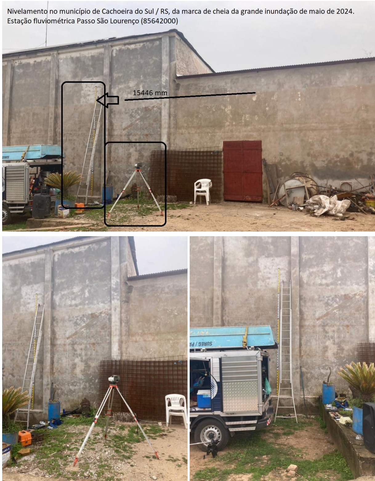
Figura 12. Marca de cheia nivelada do rio Jacuí, no município de Cachoeira do Sul / RS, referente a estação fluviométrica Passo São Lourenço (85642000).
