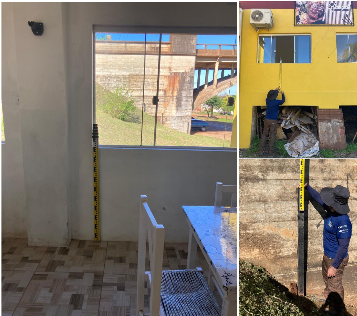
Figura 11. Marca de cheia nivelada do rio Ibicuí, no município de Manoel Viana / RS, referente a estação fluviométrica Manoel Viana (76560000).
