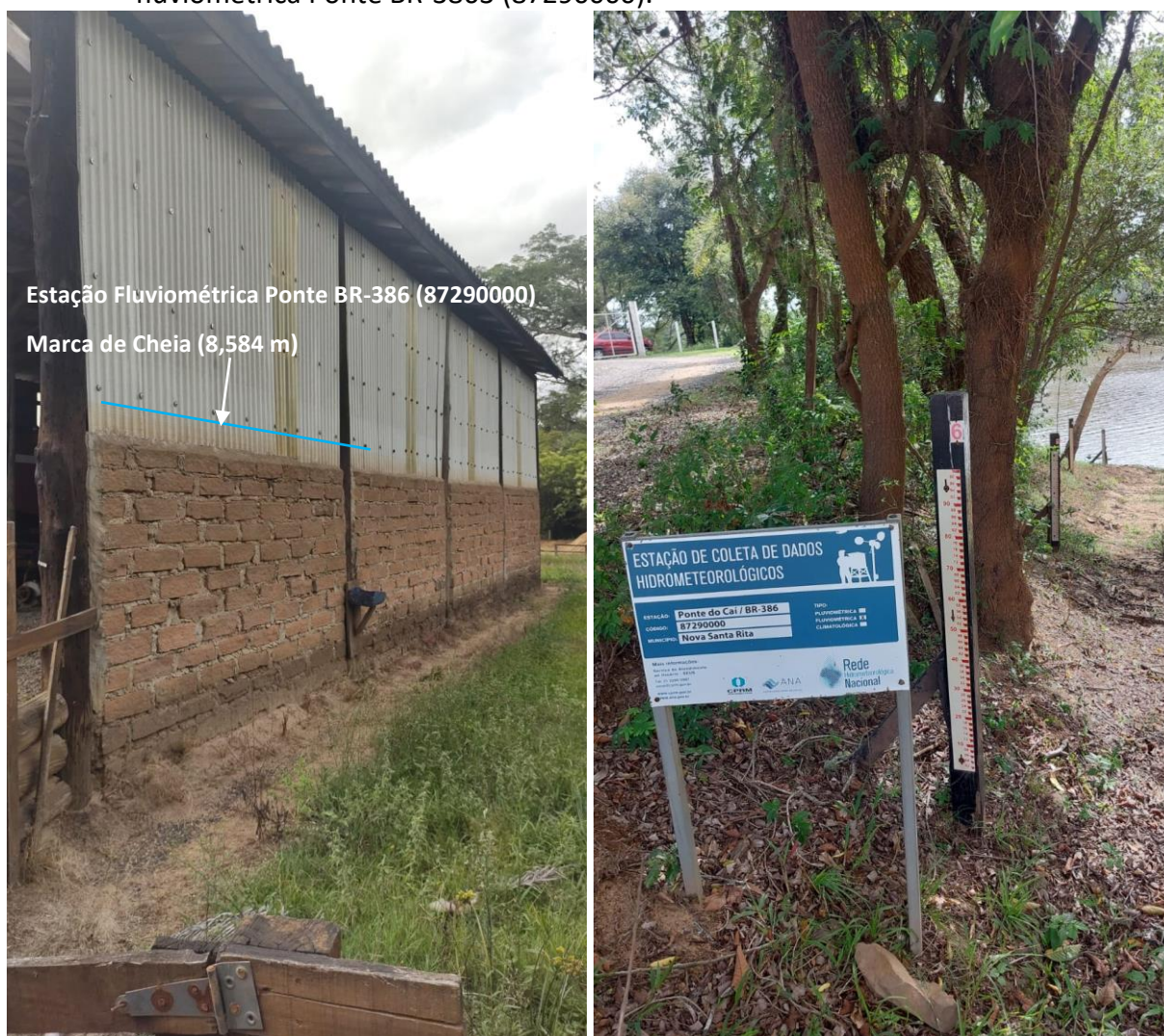
Figura 15. Marca de cheia (8,584 m) nivelada do rio Caí, no município de Nova Santa Rita / RS, na região metropolitana da capital Porto Alegre / RS, referente a estação fluviométrica Ponte BR-3863 (87290000).
