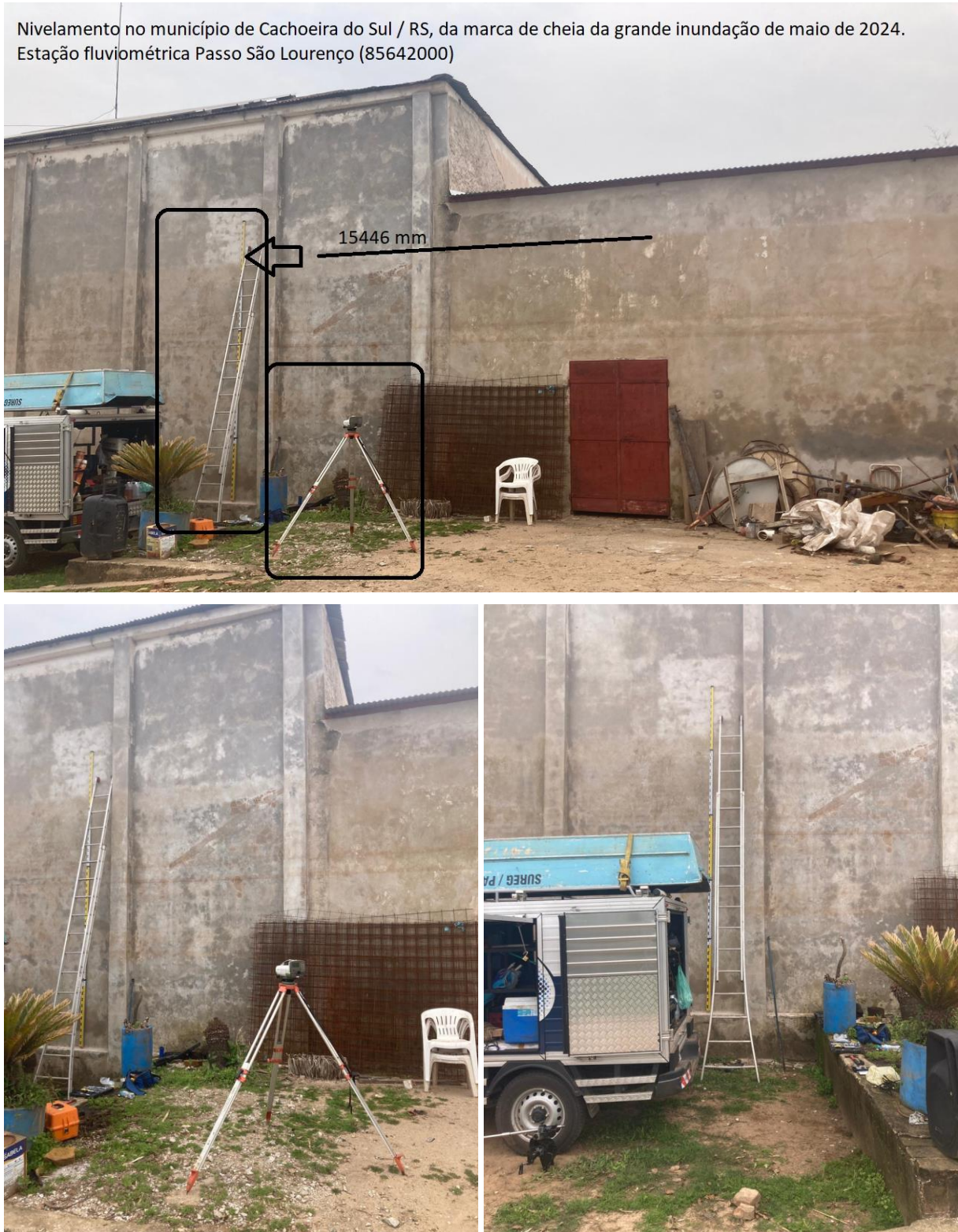
Figura 9. Marca de cheia nivelada do rio Jacuí, no município de Cachoeira do Sul / RS, referente a estação fluviométrica Passo São Lourenço (85642000).
