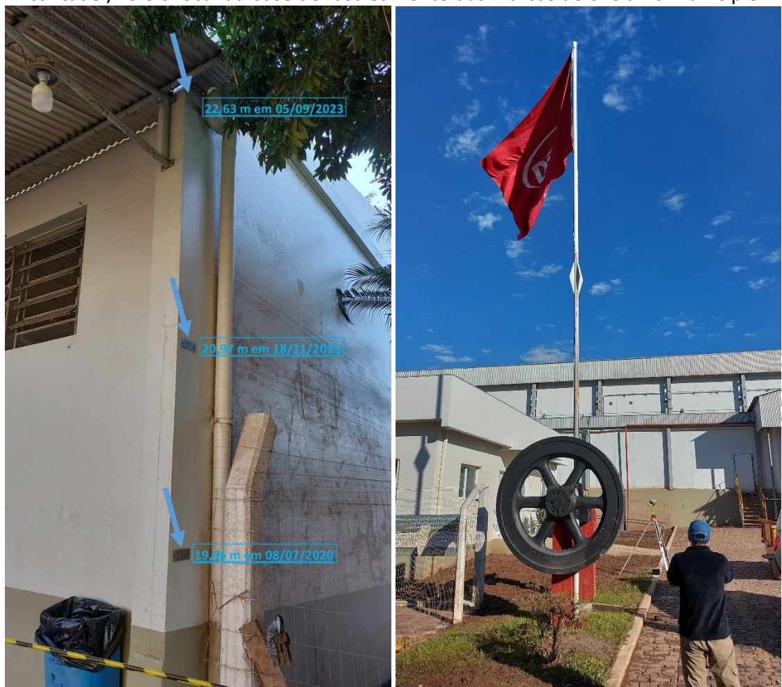
Figura 6. Locais das marcas de cheia de 08/07/2020, 05/09/2023 e 18/11/2023, no frigorífico em Encantado /RS e o local da base de rastreamento das marcas de cheia no município.
