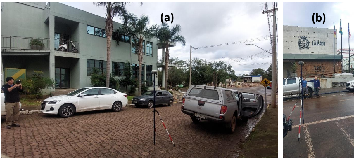
Figura 4. Levantamento com GPS-RTK na cidade de Bom Retiro do Sul (a) e em Lajeado (b).
