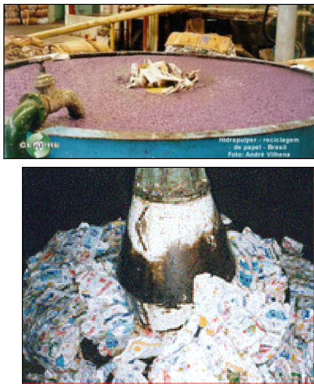
Figura 4.17. Hidrapulper vazio (abaixo) e cheio (acima), após agitação.
