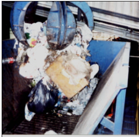
Figura 5. 3. Pólipo içando o resíduo em direção à esteira.
