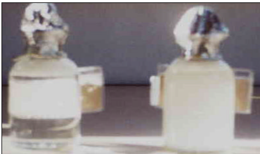
Figura 5. 19. Lavagem de PET com água. Solução de lavagem (esquerda) e efluente final (direita).
