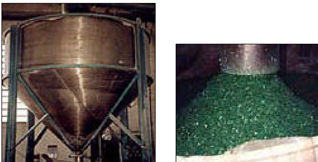
Figura 4.14. Silo de armazenamento de “flakes” (esquerda) e “flakes” prontos para o uso (direita). Fonte: Associação Brasileira dos Fabricantes de Embalagens de PET (2001).
