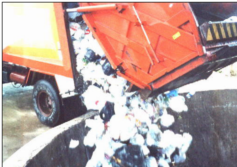
Figura 5. 1. Caminhão compactador despejando o resíduo no fosso de recepção.
