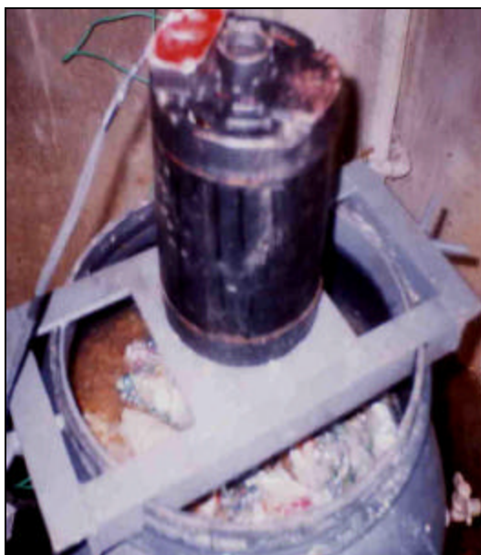
Figura 5. 22. Flotação dos filmes de polietileno e alumínio e papelão finamente dividido na solução de lavagem após desligar-se a agitação.
