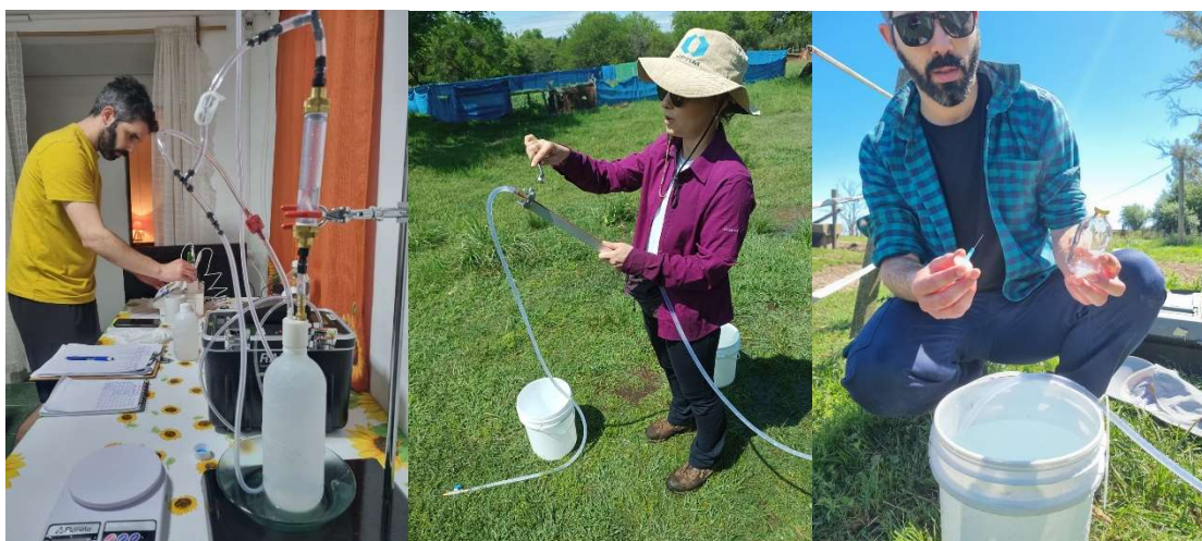
Figura 5: Laboratório de análise de radônio montado no local de hospedagem da equipe (esquerda), demonstração da coleta de amostra em tubos de cobre para análise de gases nobres (centro) e de amostras de radiocarbono (direita).
