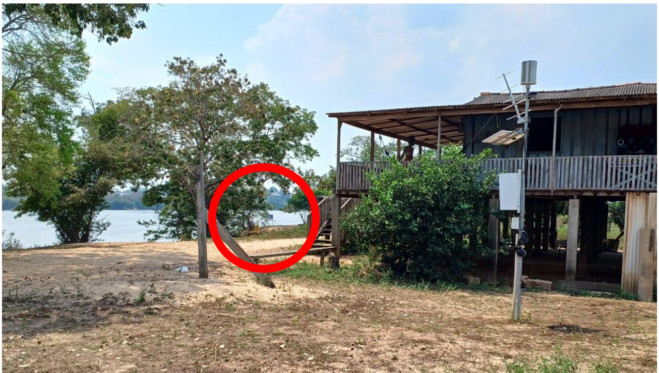
Figura 06: Localização da PCD, casa do observador e seção de réguas linimétricas da estação fluviométrica Ji-Paraná.
