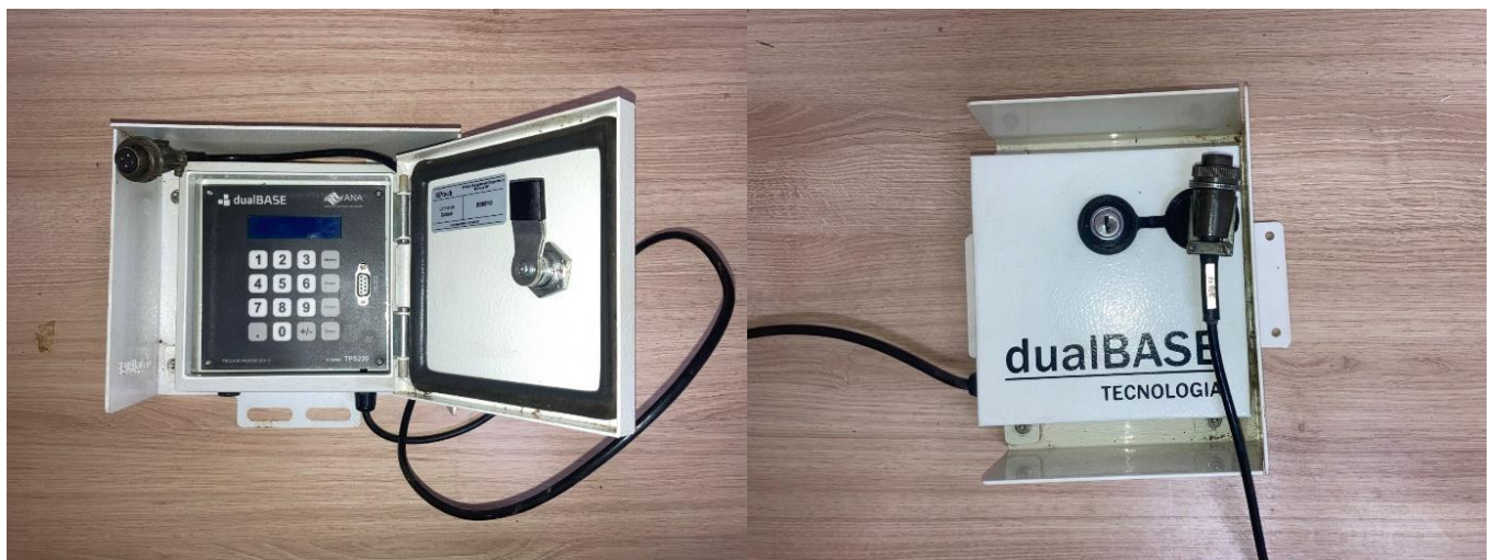
Figura 02: Display para inserção de dados de cota obtidos por meio de leitura de réguas linimétricas.
