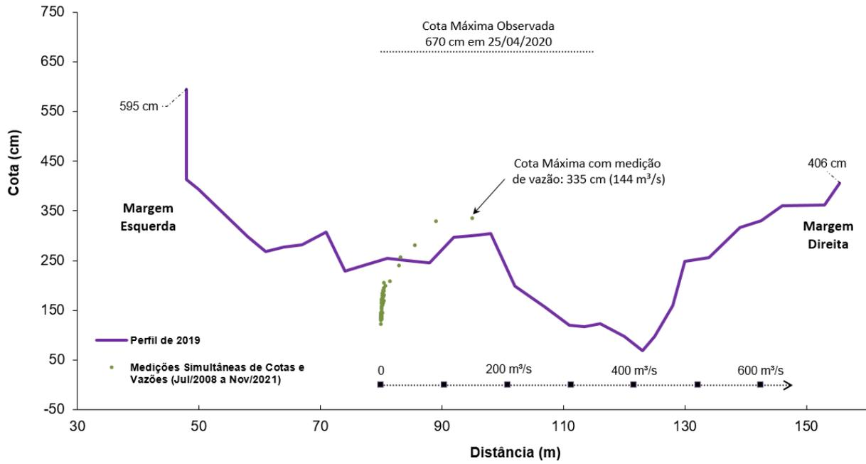
Figura 03 – Perfil da seção transversal da seção de régua de Divisa PB-RN. Fonte: elaborado pelos autores.
