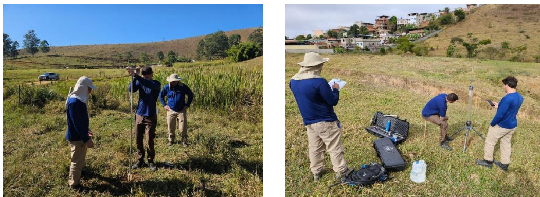
Figura 8 – Realização da sondagem para instalação do permeâmetro e equipamento realizando o ensaio, respectivamente.
