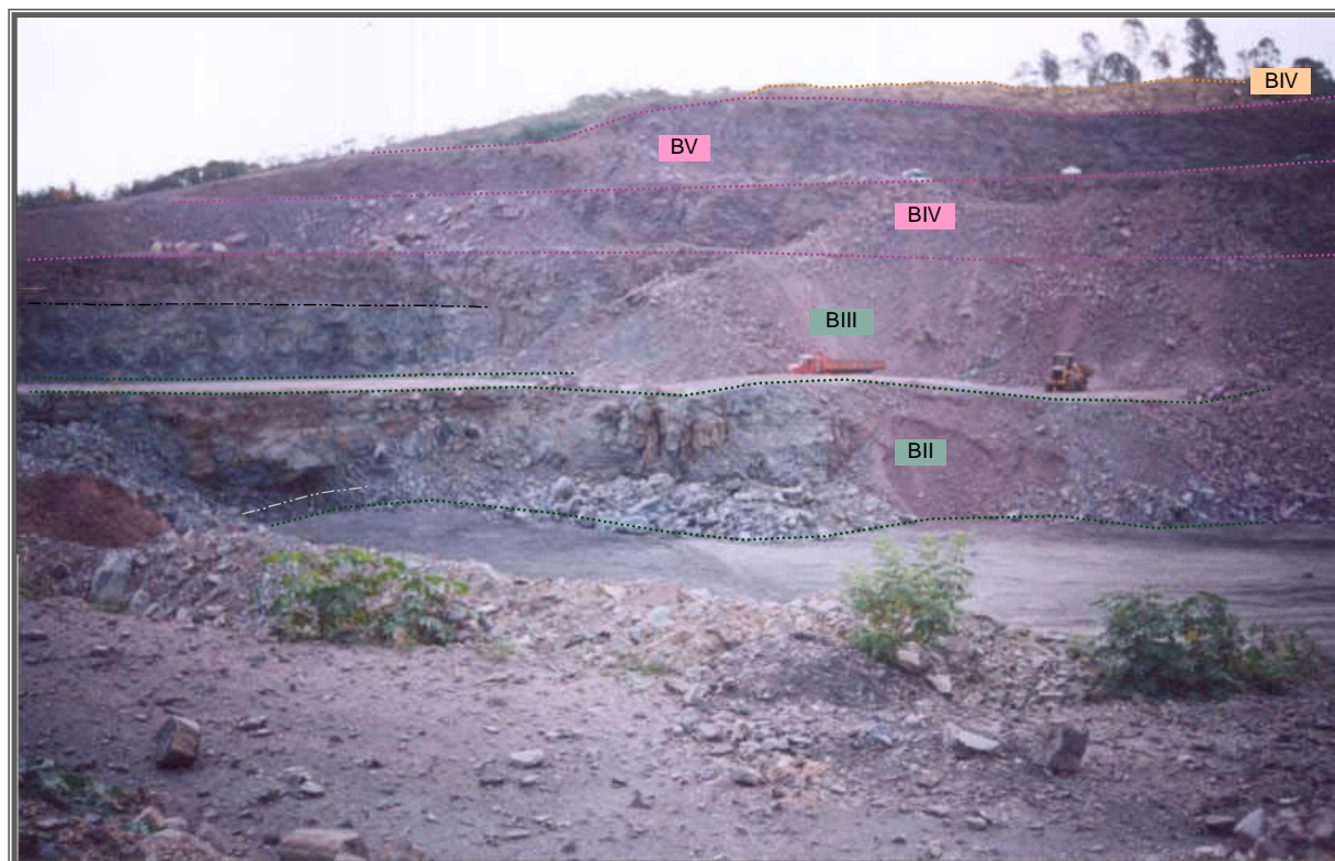
Figura III.9: Vista Parcial da região centro-sul da lavra, compreendendo cinco das sete bancadas existentes em 11/2001. As duas bancadas inferiores são predominantemente da Formação Serra Alta e as três superiores da Formação Corumbataí. B (II, III...V) = bancadas.
