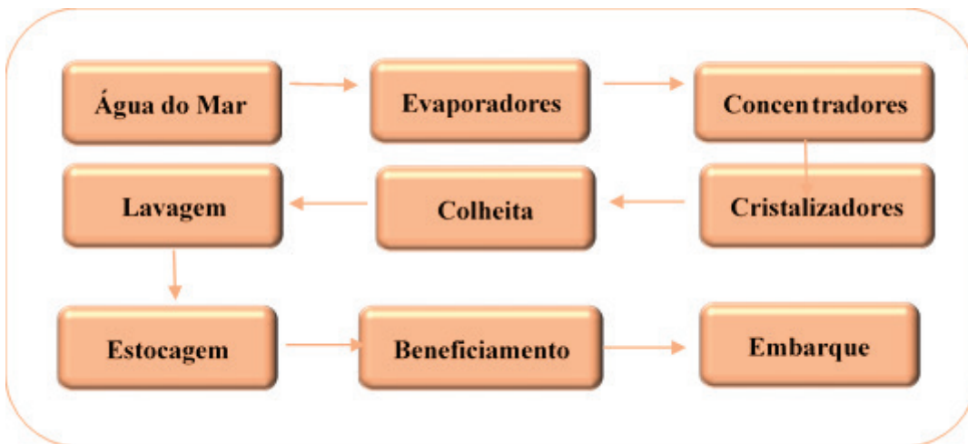
Figura 9.11 - Diagrama esquemático da cadeia produtiva do sal marinho. Fonte: Cimsal (2023). Adaptado por SGB/SEDEC (2023).
