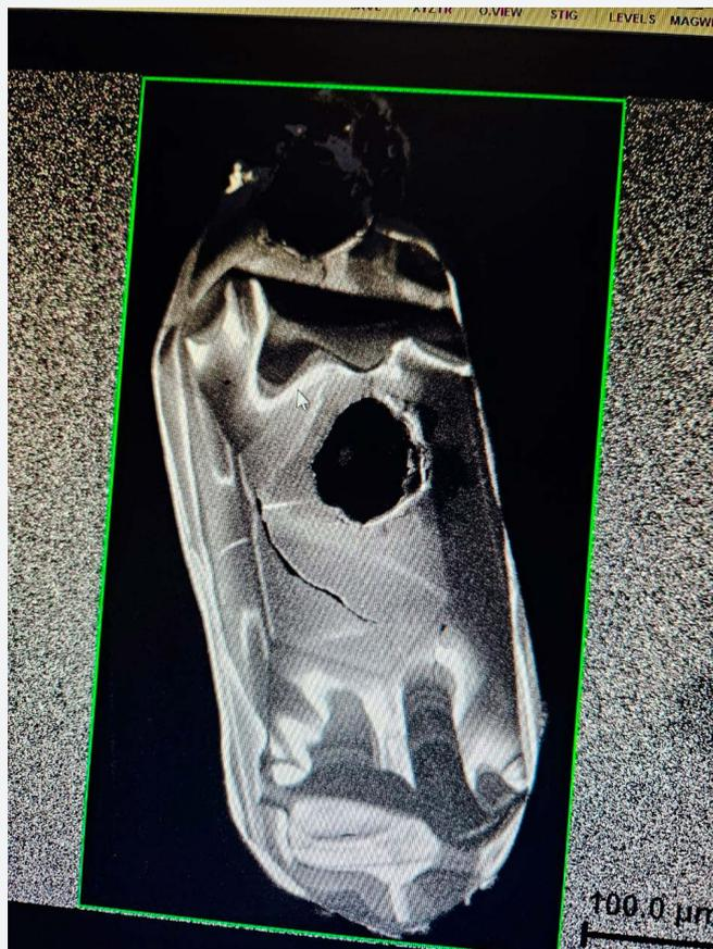
Imagem de cristal de zircão selecionado para análises geocronológicas, capturada no Microscópio Eletrônico de Varredura do SGB-CPRM.
