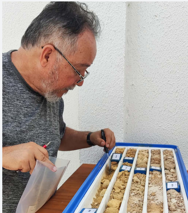
Amostragem de testemunho de sondagem. Litoteca de Mossoró. Crédito Pamela Emanuelle da Silva.
