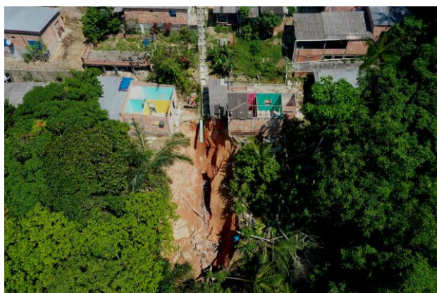
Figura 19- Erosão ocasionada pela concentração das águas pluviais e servidas pela tubulação. (Autores)
