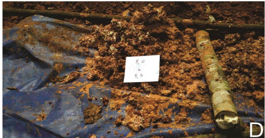
**Figura 16:** A) Material amarelo retirado do intervalo entre 0,5 e 1,0 metros. B) Material laranja avermelhado com nódulos retirado do intervalo entre 3,5 e 4,0 metros. C) Material branco avermelhado com nódulos retirado do intervalo entre 4,0 e 4,5 metros. D) Material branco rosado com nódulos retirado do intervalo entre 5,0 e 5,5 metros.
