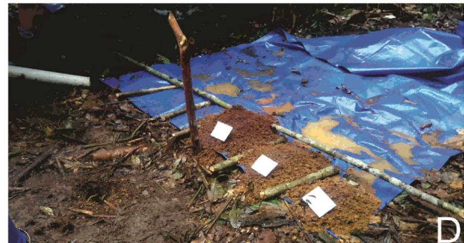
**Figura 14:** A) Material amarelo tirado do intervalo de 0,0 e 0,5 metros. B) Nódulos de laterita oxidados são encontrados no intervalo entre 0,5 a 1,0 metros. C) O solo se torna mais laranja no intervalo entre 1,0 e 1,5 metros. D) Todo o material do furo é disposto sobre a lona para descrição, fotografia e coleta.
