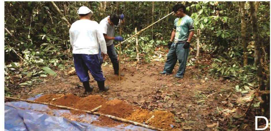
**Figura 18:** A) Material amarelo retirado do intervalo entre 0,0 e 0,5 metros. B) O mesmo material amarelo, gradando de cor. C) Material vermelho, misturado com material marrom, ambos com nódulos pretos, do intervalo entre 2,5 a 3,0 metros. D) Disposição das amostras do trado na lona para coleta e análise.
