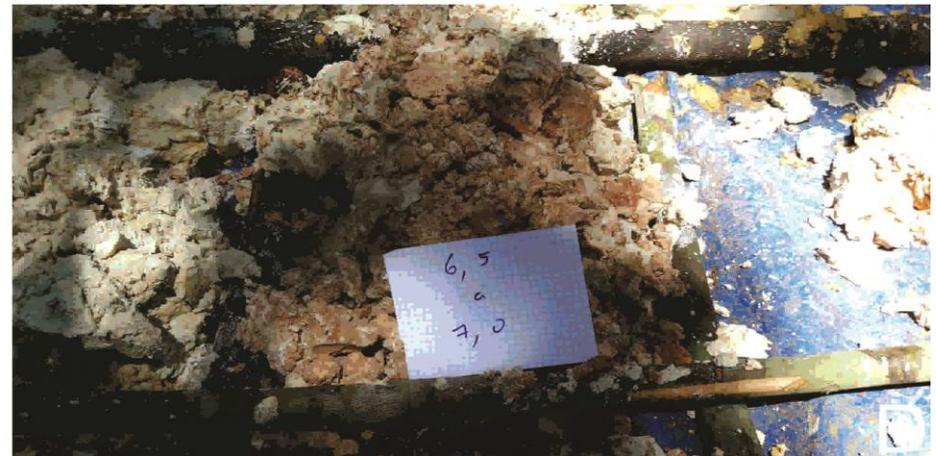
**Figura 19:** A) Material amarelo retirado do intervalo entre 0,0 e 0,5 metros. B) Material branco rosado retirado do intervalo entre 1,5 e 2,0 metros. C) A coesão do material é excelente, sendo recuperadas amostras em vários formatos. Além de ter seixos de quartzo na matriz. D) Material vermelho retirado do intervalo entre 6,5 a 7,0 metros, no final do furo.
