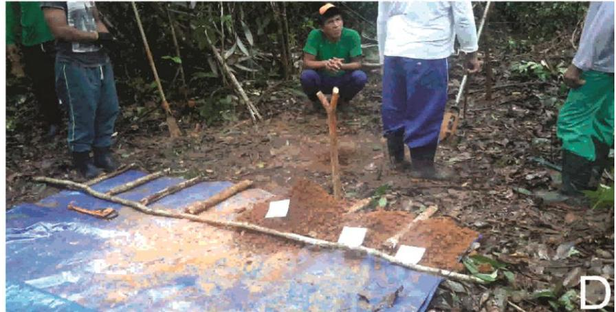
**Figura 17:** A) Material amarelo retirado do intervalo entre 0,0 e 0,5 metros. B) Material amarelo com nódulos vermelhos retirado do intervalo entre 0,5 e 1,0 metros. C) Material rosa com nódulos vermelhos retirado do intervalo entre 1,00 a 1,50 metros. D) Disposição do material na lona para análise.
