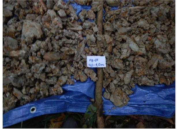
Figura 5: Aspectos da perfuração e do material atravessado em dois intervalos do furo FB-01.
