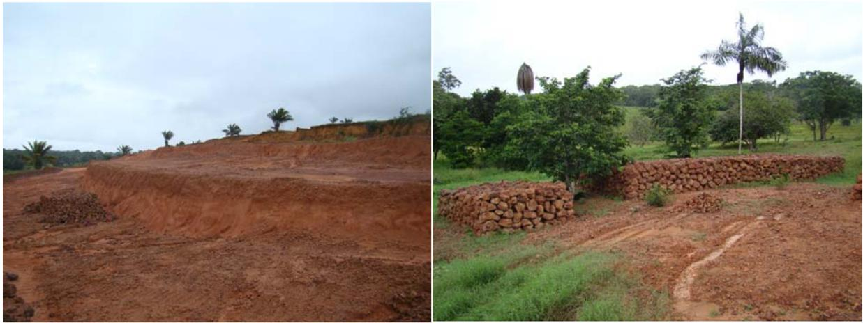
Figura 11: Vistas do local de exploração de crosta laterítica, em blocos destinados à construção civil, nas adjacências de uma das áreas avaliadas (vide Figura 2).
