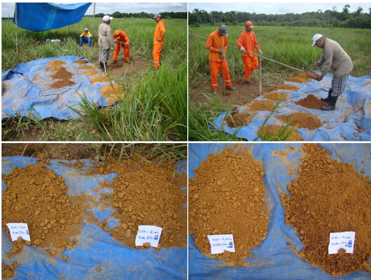
Figura 10: Aspectos da perfuração e do material atravessado em quatro intervalos do furo ITC-06
