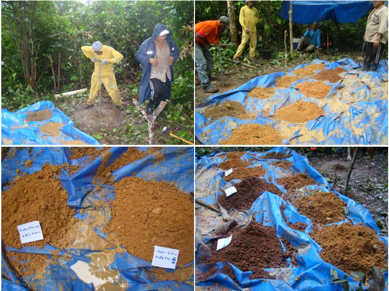
Figura 8 - Aspectos da perfuração e do material atravessado em vários intervalos do furo ITC-04.
