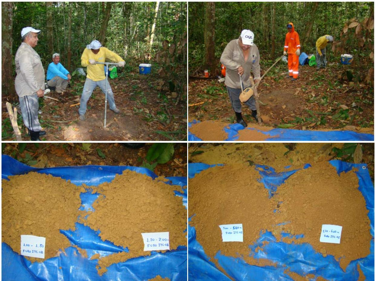
Figura 6 - Aspectos da perfuração e do material atravessado em quatro intervalos do furo ITC-02
