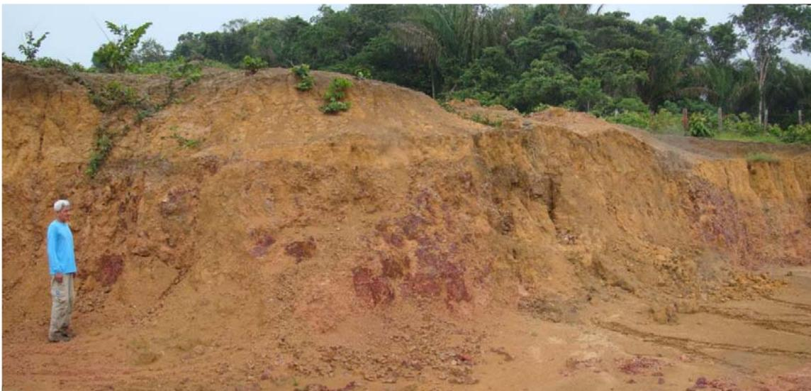
Figura 12: Vista frontal de barranco que foi escavado para lavra de crosta laterítica onde pode ser observado o perfil típico do solo local e a espessura métrica da crosta avermelhada.
