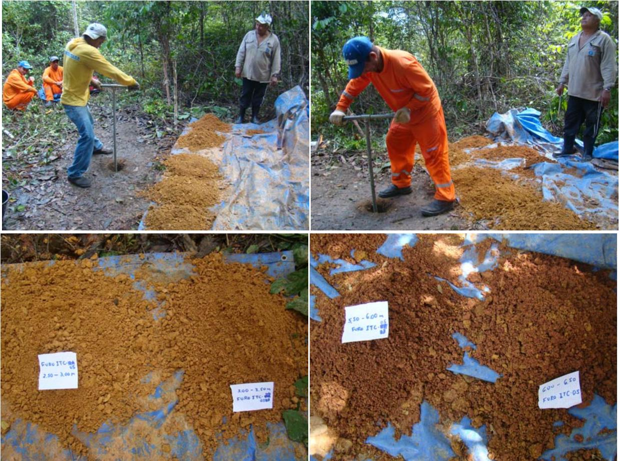
Figura 9: Aspectos da perfuração e do material atravessado em quatro intervalos do furo ITC-05
