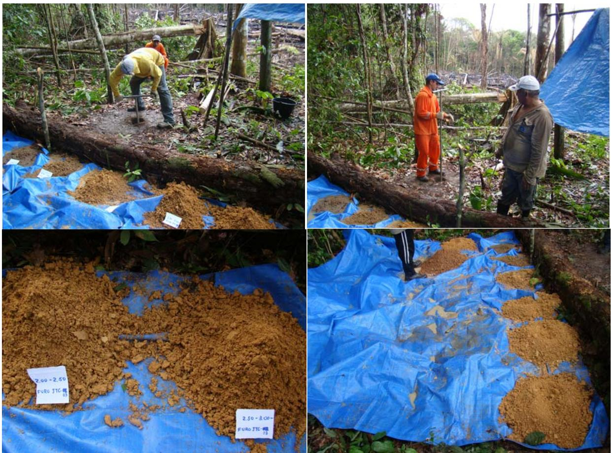
Figura 7 - Aspectos da perfuração e do material atravessado em vários intervalos do furo ITC-03.
