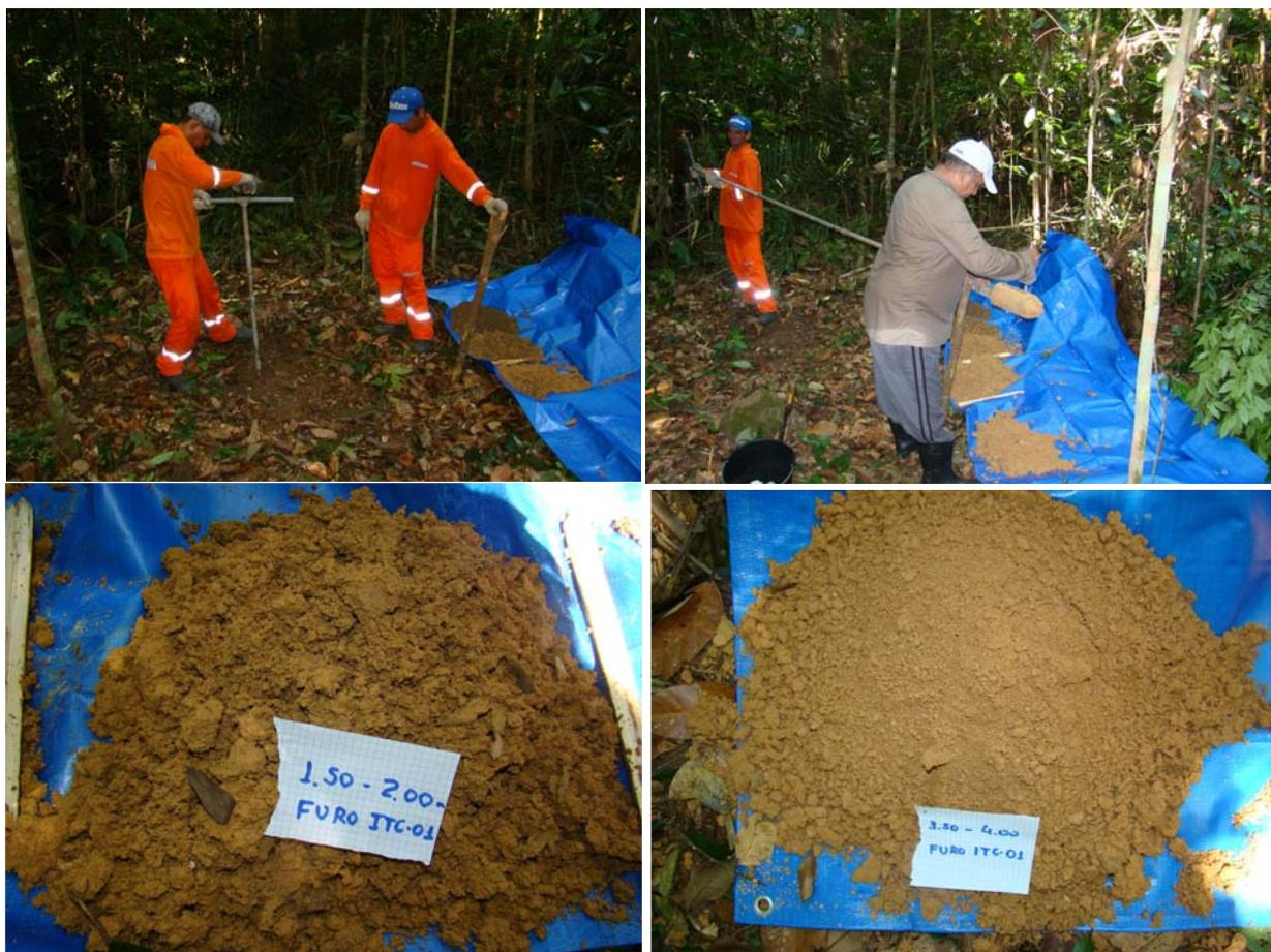
Figura 5 - Aspectos da perfuração e do material atravessado em dois intervalos do furo ITC-01.
