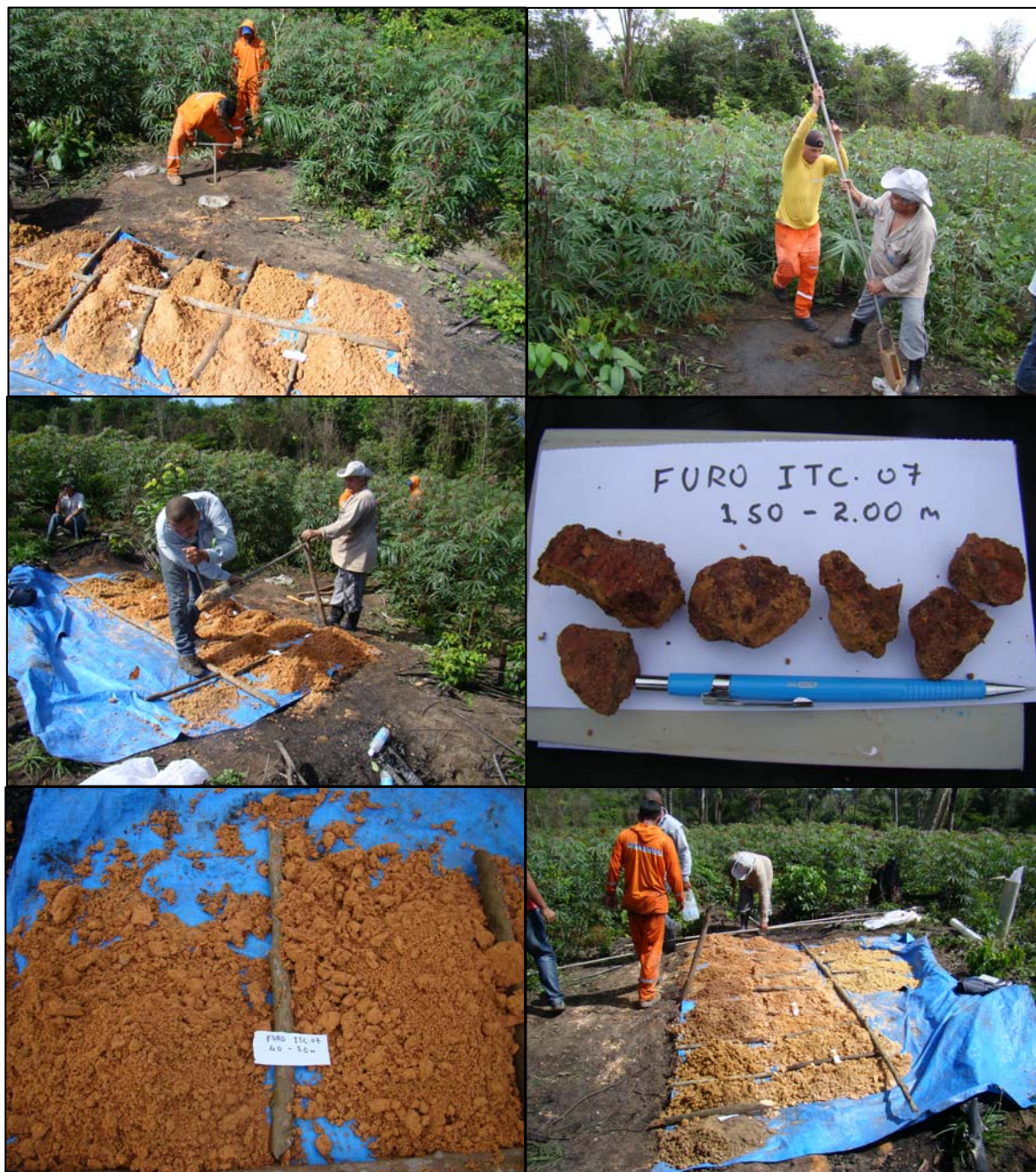
Figura 2: Aspectos da perfuração e do material atravessado pelo furo ITC-07 no limite norte da área avaliada.
