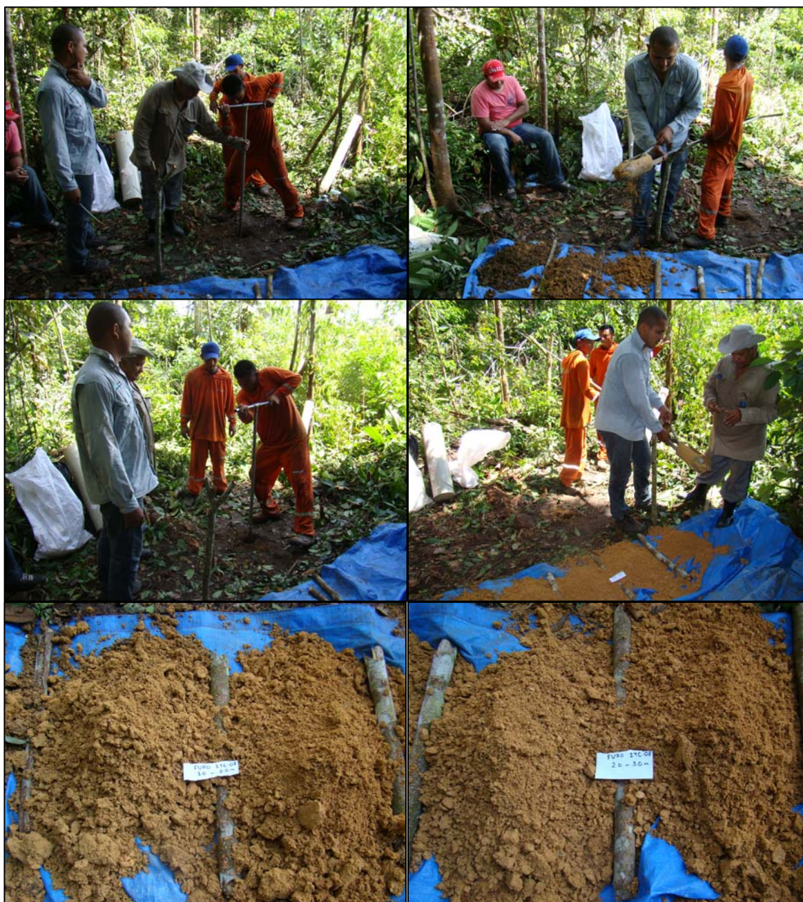
Figura 3: Aspectos da perfuração e do material atravessado pelo furo ITC-08.
